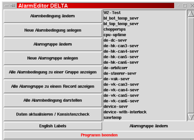
Abbildung 9.3: Hauptfenster des Editors für Alarmbedingungen. Auf der rechten Seite wird eine Namensliste der bereits existierenden Alarmgruppen angezeigt.
