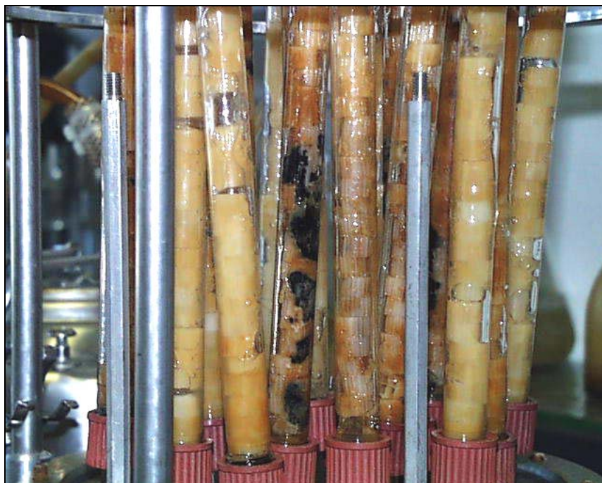
Abbildung 16: Biofilmbildung mit aeroben und anaeroben Zonen in den Glasröhren von Reaktor 2
