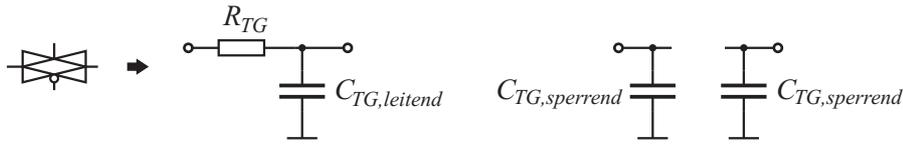
**Abbildung 6.6:** Ersatzschaltbilder für ein Transmission-Gate im leitenden und im sperrenden Zustand
