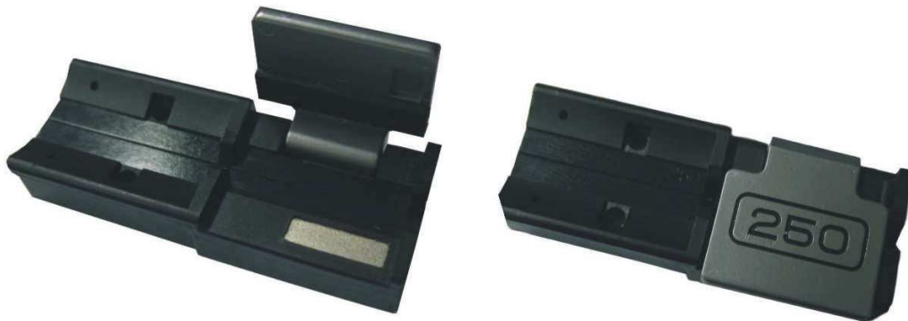
Abbildung 8.16: Glasfaser Klemmvorrichtung für die Handhabung der Fasern zwischen Entmantel-, Cleaver- und Spleiß-Geräten
