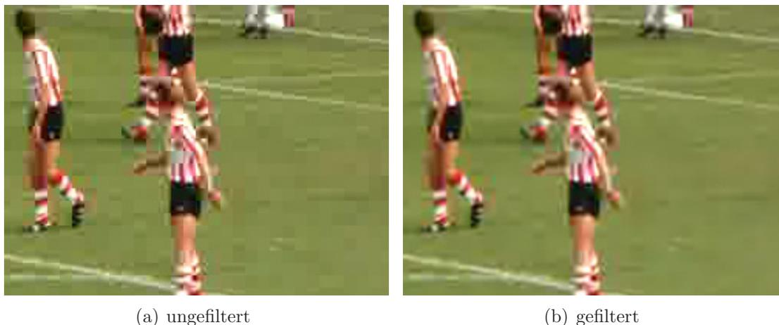
**Abbildung 5.6:** Bildbeispiel für die Artefaktreduktion durch Subtraktion von Fehlersignalen (Ausschnitt)
