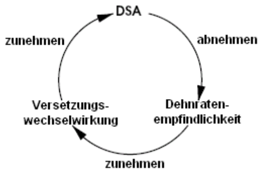
Abb. 2.7: Das Zusammenspiel von DSA, Dehnratenempfindlichkeit und Versetzungswechselwirkung führt zu einem selbstorganisierten Rückkopplungsprozess [24].
