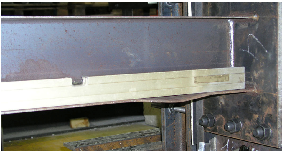
Bild 3.7: Lokale Beulverformung in Auflagernähe am Beispiel des Versuchskörpers 4B
