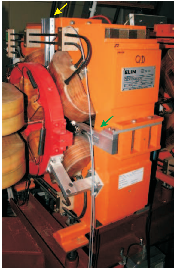
Abbildung 9.2: Wegaufnehmerhalterungen an den Quadrupol-Jochen mit Wegaufnehmern und Verkabelung zur Messung der vertikalen (gelber Pfeil) und horizontalen (grüner Pfeil) Bewegung des BPM-Kopfes.
