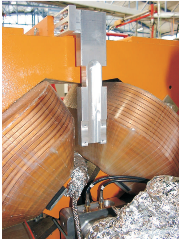
Abbildung 9.1: Wegaufnehmerhalterung am Quadrupol-Joch.
