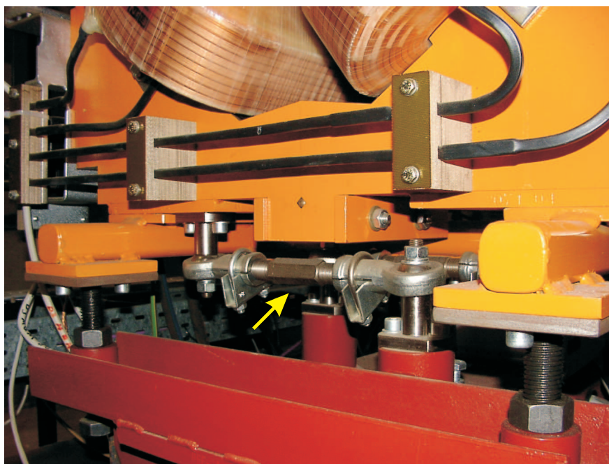
Abbildung 4.12: Radiale Justage der Quadrupol-Magnete mit Gewindestangen (gelber Pfeil).
