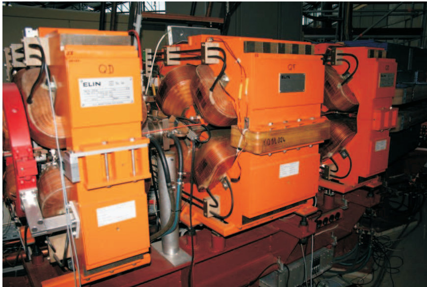
Abbildung 4.9: Ein Delta-Triplett mit drei Quadrupol-Magneten.
