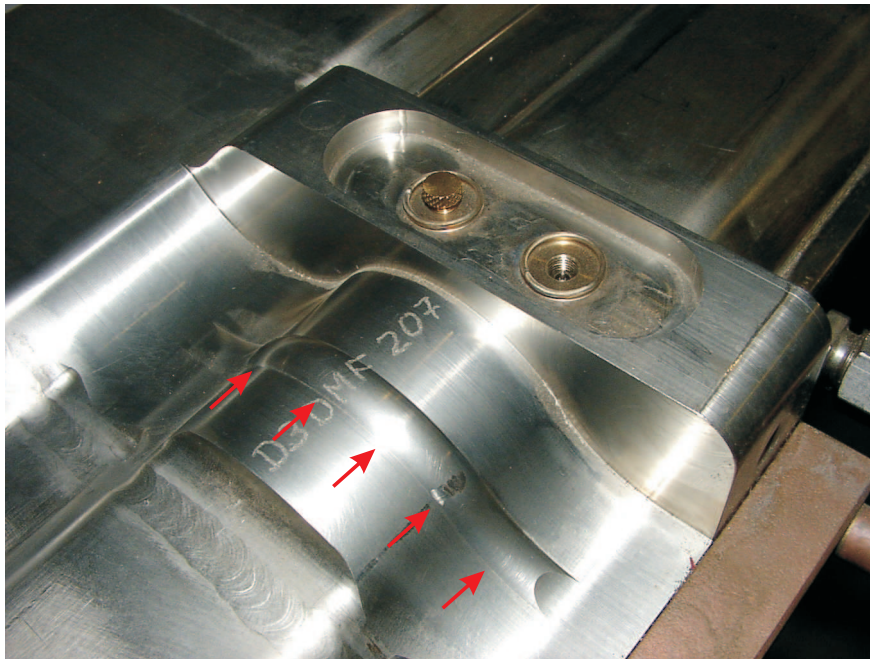
Abbildung 6.2: Standard-Monitorkopf in Delta. Die im Bild erkennbare Wulst soll die zentrische Lage der Vakuumkammer im angrenzenden Quadrupol gewährleisten. Die Wulst des Monitorkopfes unterscheidet diesen fixierten BPM von einem variablen. An den roten Pfeilen liegt die Wulst am Magneteisen des Quadrupols an [17].
