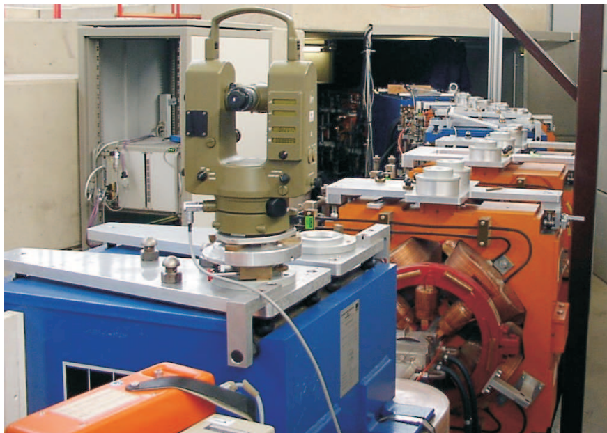
Abbildung 6.7: Aufbau für die geodätische Vermessung an Delta. Auf den Magneten befinden sich Messplatten, im Vordergrund ist ein Theodolit montiert.
