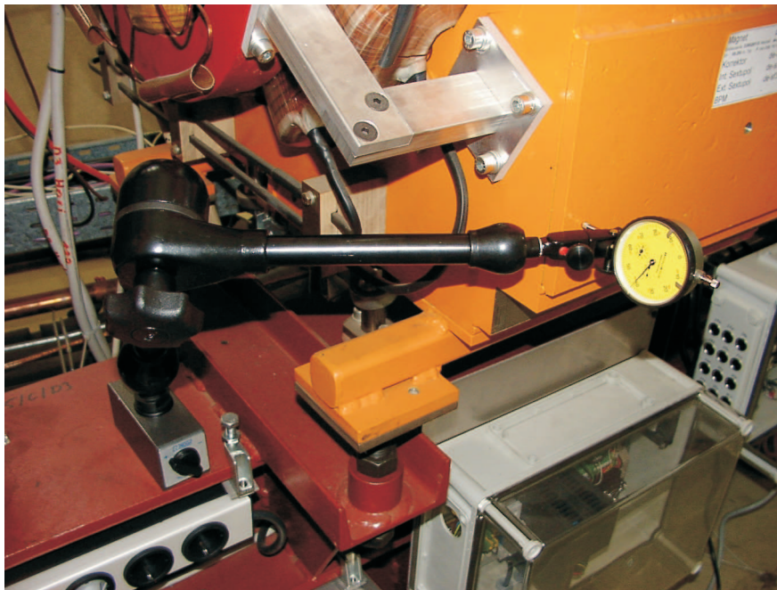
Abbildung 8.7: Mechanische Messuhr mit Haltearm.
