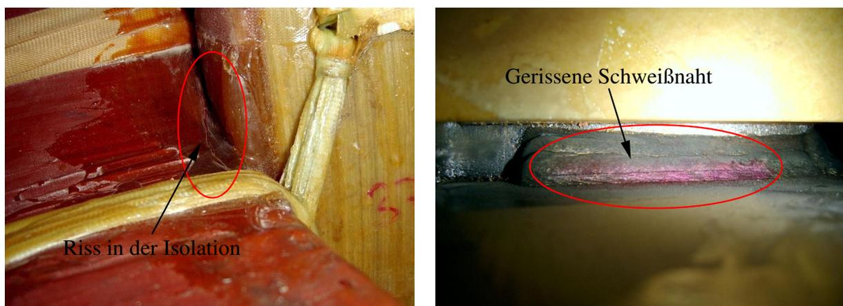
Abbildung 1.3 – Beispiele für Schäden im Wickelkopfbereich
