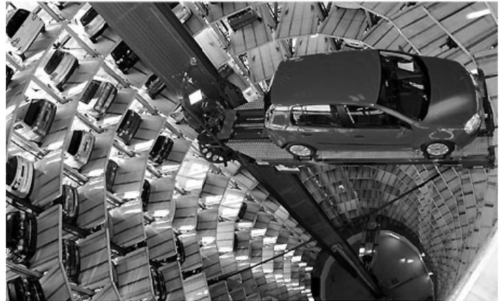
Abb. 2.13 Geschl. Turmsystem /WÖH06b/ Abb. 2.14 Radialsystem von innen /PAL06/
