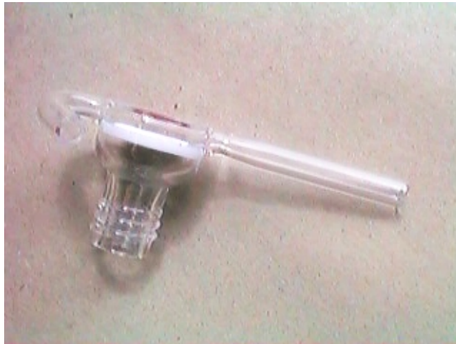
Abbildung 6.2: Das Glasgefäß der Quecksilberzelle
