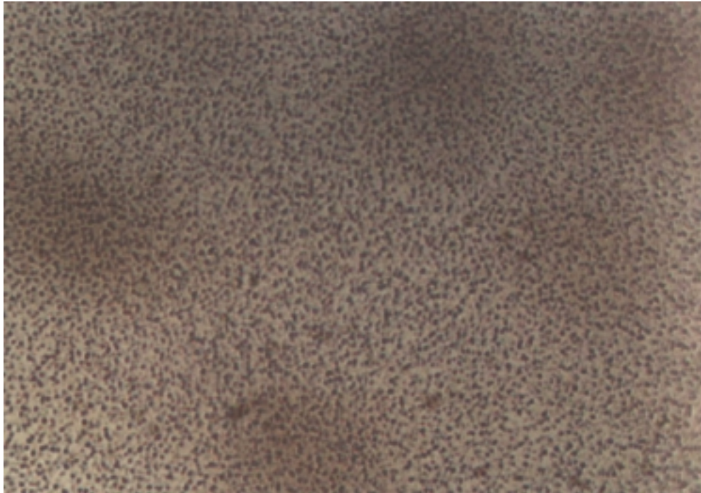
Abbildung 5.12: Tempern bei 415°C und 15 Minuten
