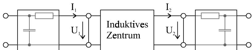
Bild 6.1.3 1 Trafo als Kettenmatrix
