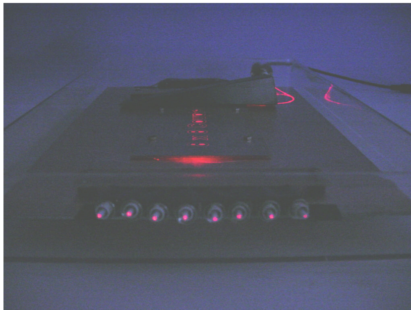
Abbildung 5.35: Acht Ausgänge eines Kaskadenkopplers. Eingestrahlt wird durch einen Kanal.
