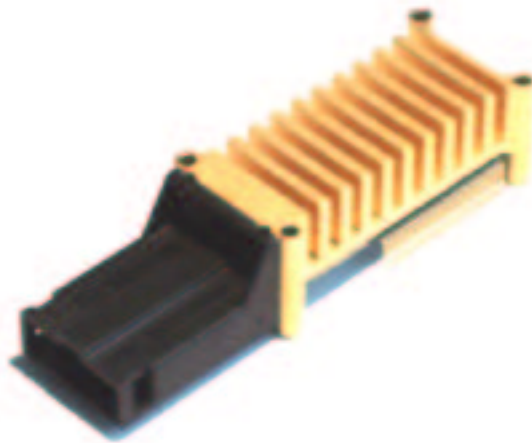
Abbildung 2.3: Das Paroli Modul von Infineon (Länge des Bauteils: 5 cm).
