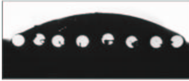
Abbildung 4.8: Foto vom Querschnitt des hergestellten Bändchen (Faserdurchmesser: 125 \mu m .)
