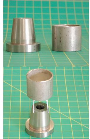
Die Maschinendrehteile werden auf CNC- gesteuerten Drehbänken sehr exakt gefertigt, sind aber im Vergleich zu Gußteilen durch die Einzelfertigung teurer. Diese Genauigkeit des maschinengefertigten Anschlusselements ist, im Gegensatz zum Maschinenbau, für den Hochbau nicht unbedingt erforderlich. [16]
