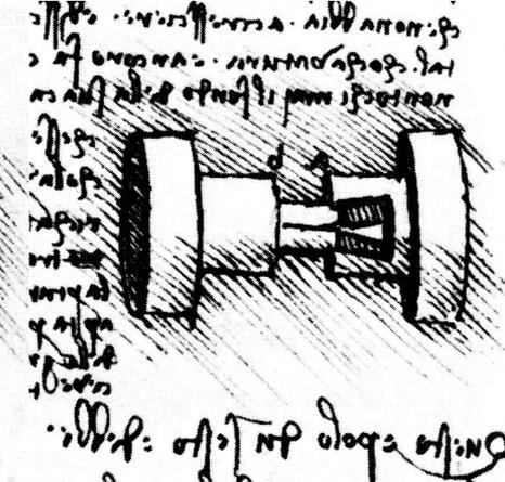
Die weiteren Konstruktionszeichnungen Leonardos zeigen Steckverbindungen ähnlicher Konstruktion, die aber durch eine zusätzliche Verzahnung oder eine rechteckige Ausbildung des Stabkopfes neben Zug- und Druckkräften außerdem Torsionskräfte übertragen können.
