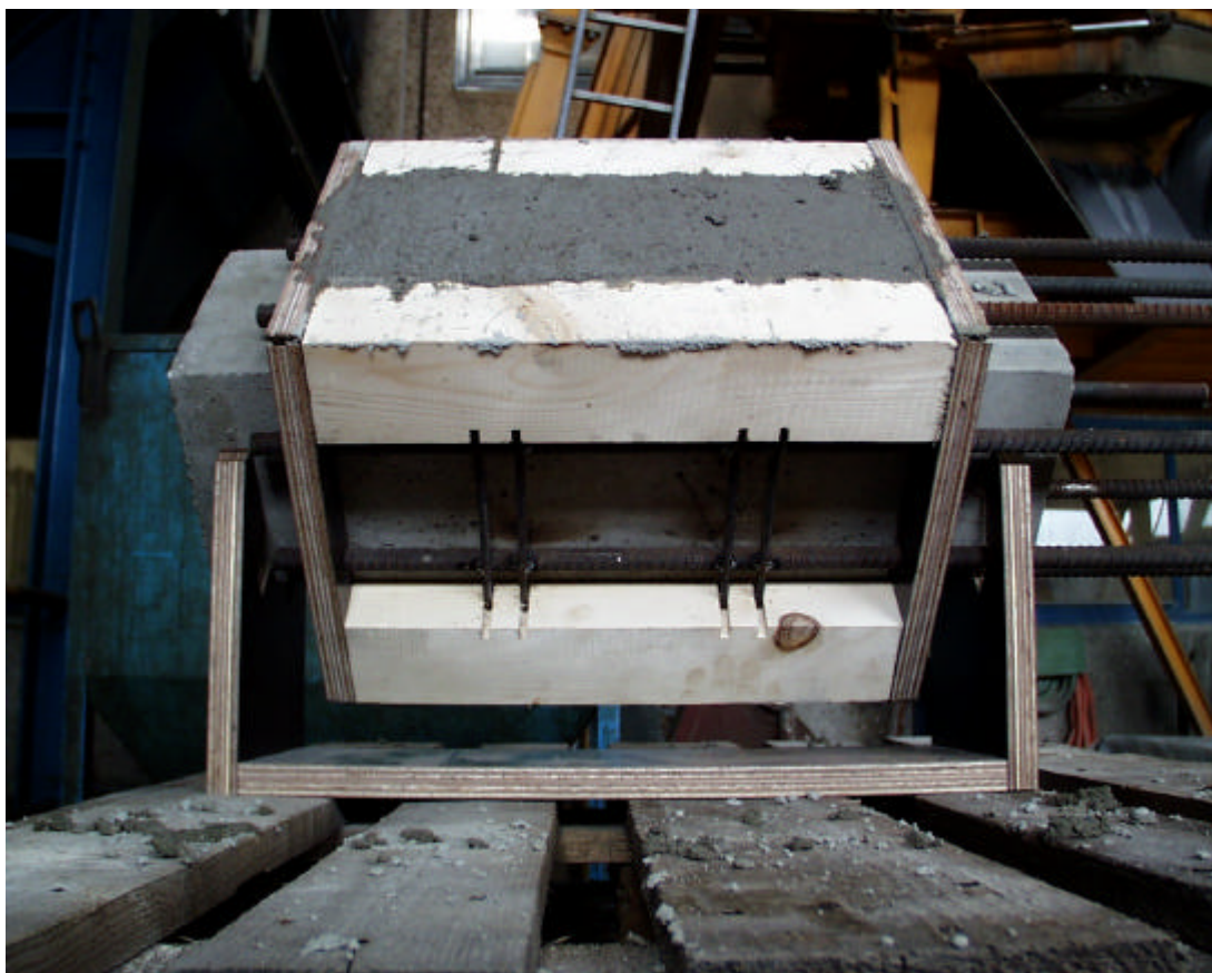
Abb. 8.15 : Die erste Betoniervorgang
