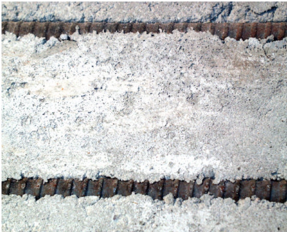
Abb. 8.94 : Abdruck eines Schalungsrau belassenen Untergrundes, Serie C
