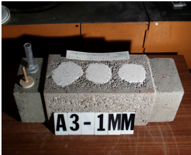
Abb. 8.4 : Durchführung des Sandflächenverfahrens
