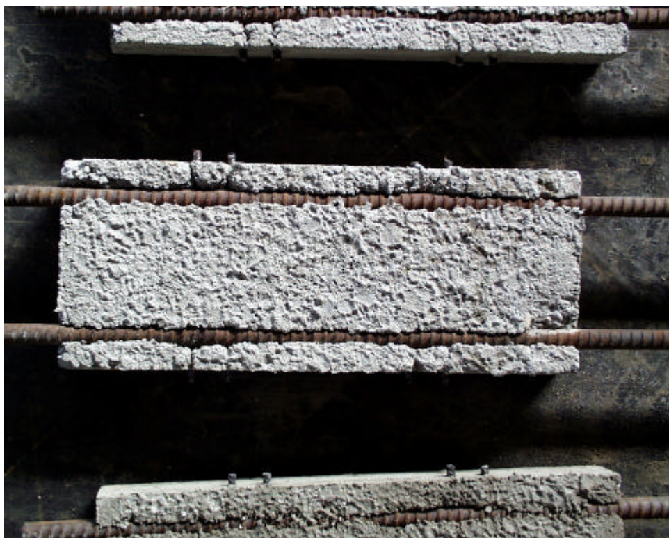
Abb. 8.18 : Die getrennten Verstärkungsschichten
