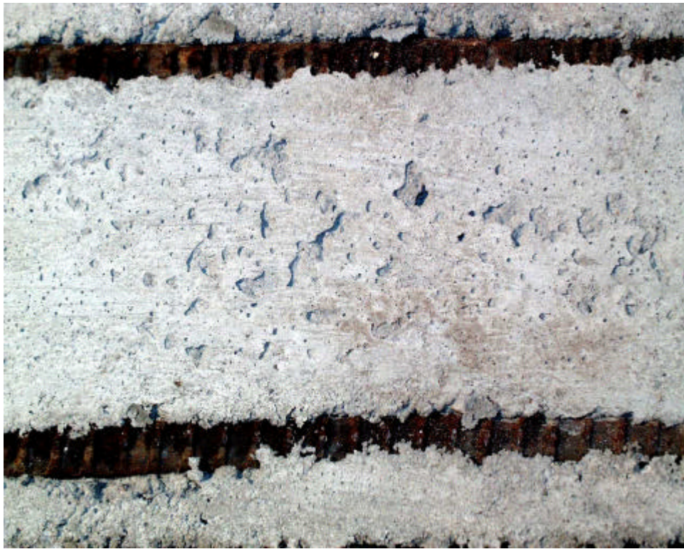
Abb. 8.90 : Abdruck eines schalungsrau belassenen Untergrundes, Serie A
