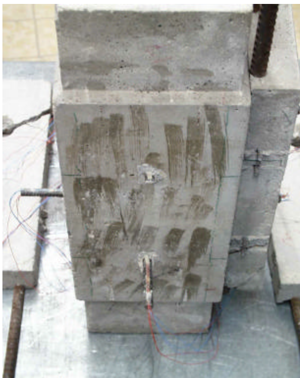
Abb. 8.45 : Versagen durch Dübelermüdung
