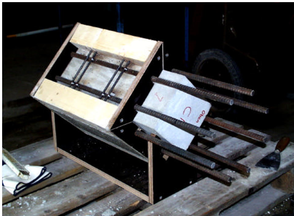
Abb. 8.12 : Aufbau und Betonierichtung der Verstärkungsschichten
