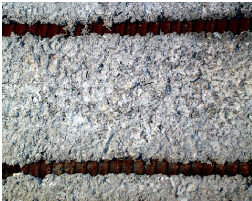
Abb. 8.93 : Abdruck eines aufgerauten Untergrundes, Serie B
