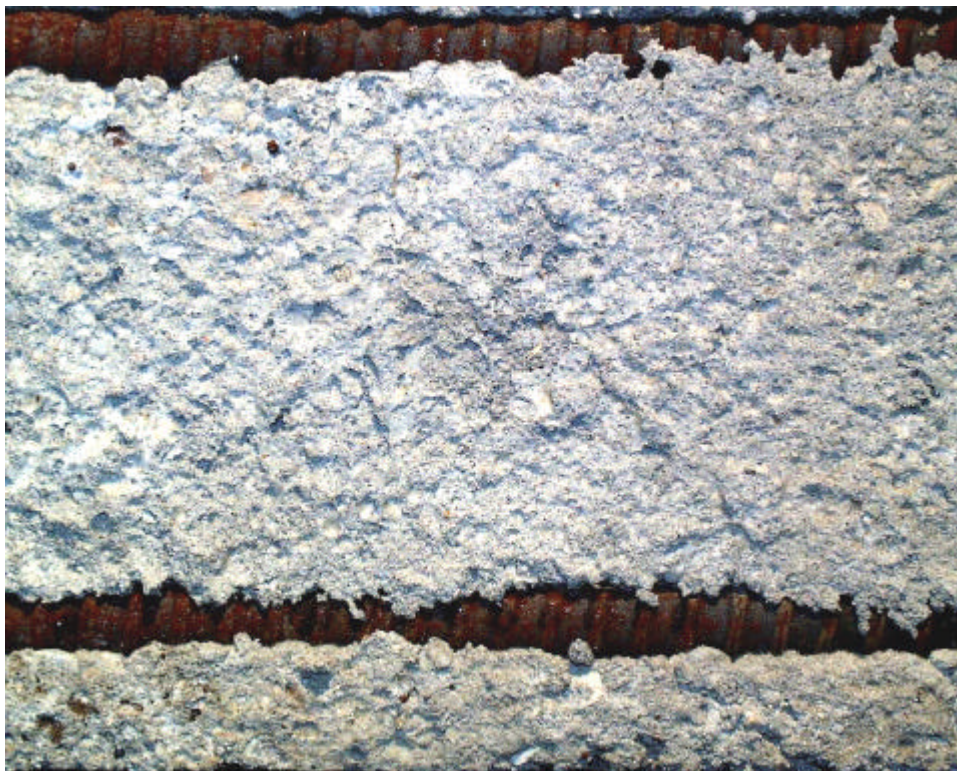
Abb. 8.95 : Ein Abdruck ein aufgeraute Untergrund (Serie C).
