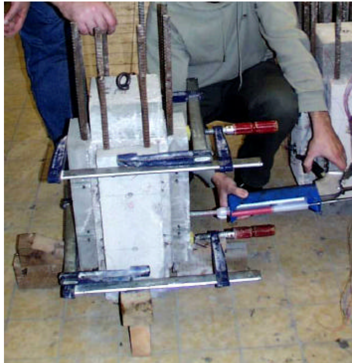
Abb. 8.26 : Einbringen des Klebstoffs
