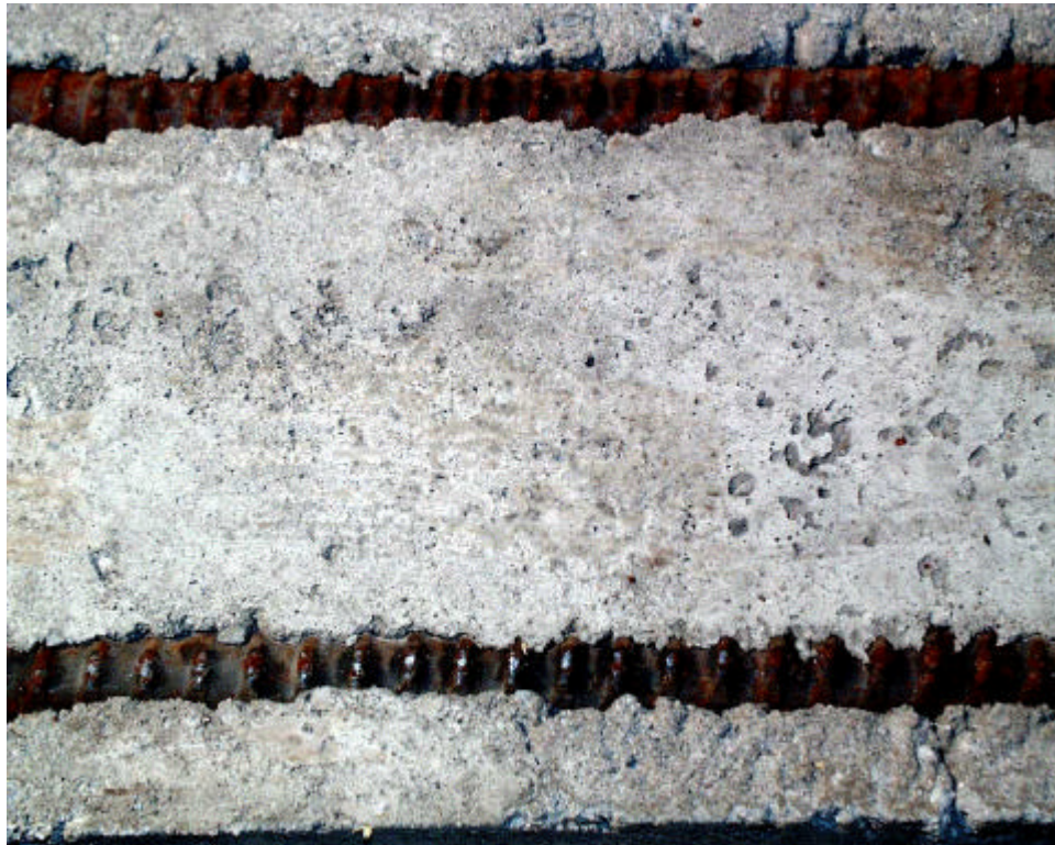
Abb. 8.92 : Abdruck eines schalungsrau belassenen Untergrundes, Serie B
