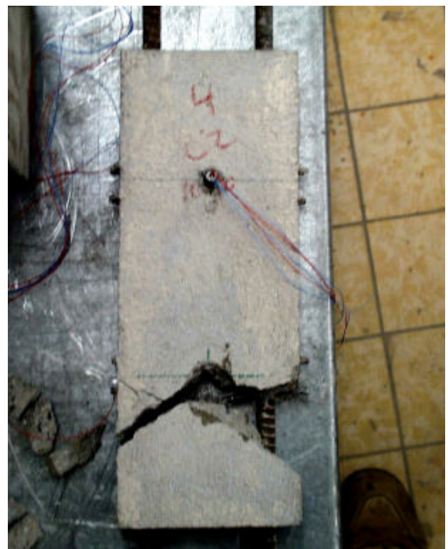
Abb. 8.46 : Heilgebliebene oberer Dübelbereich trotz Dübelversagens
