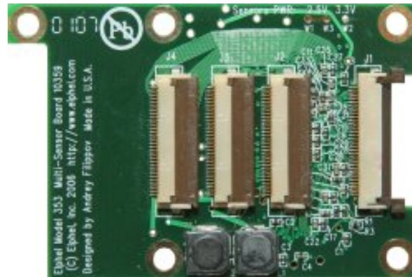
Abbildung 7.7.: Dies ist das 10359-FPGA-Board von oben gesehen. J1 ist die Verbindung zum 10353, J2 bis J4 werden verwendet, um Sensoren zu verbinden [Fil].
