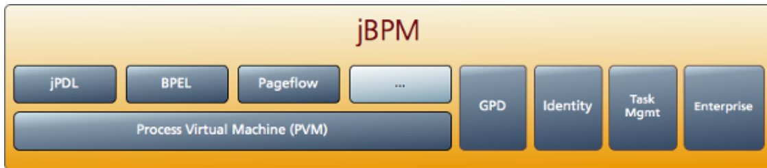
Abbildung 3.4.: Komponenten des jBPM-Frameworks 1
