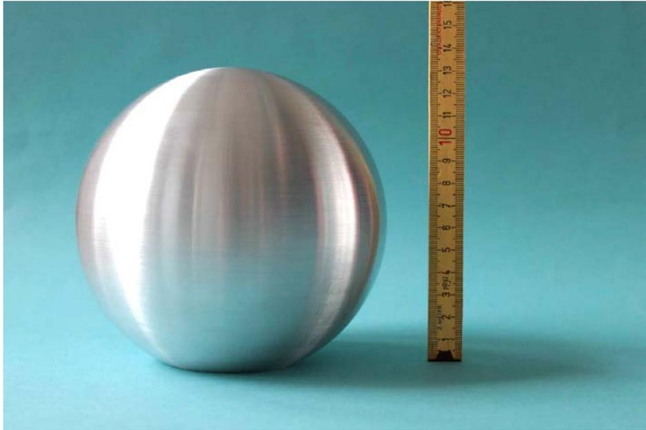
Abbildung 5.22: Kugelsegmentdiffusor aus massivem Aluminium,  $r_K = 68 \text{ mm}$  und  $h = 129,2 \text{ mm}$
