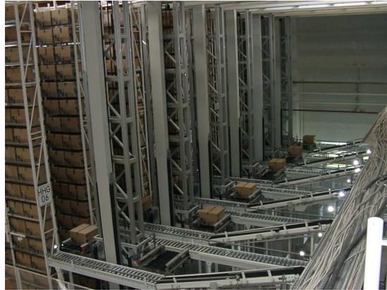
**Abbildung 2.6:** Automatisches Kleinteilelager [Quelle: KTL]
