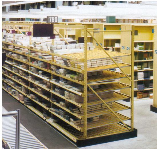
Abbildung 2.7: Schwerkraftdurchlaufregallager [Quelle: SSI Schäfer]
