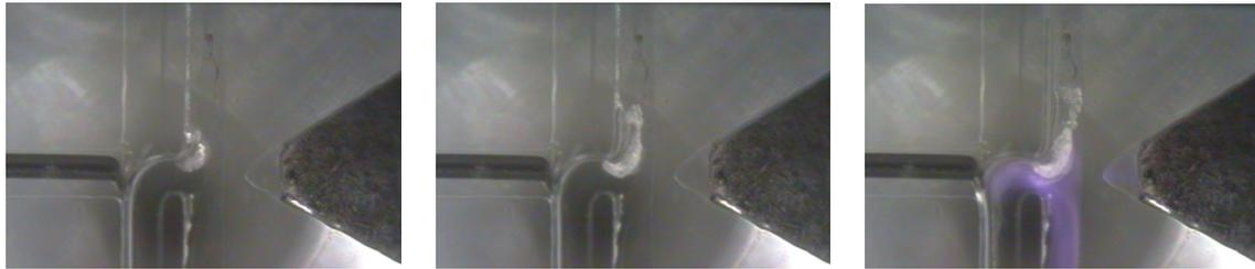
Abbildung 4.17: Fünftes Chipdesign: Elektrospray im Chip. Die chronologische Bildsequenz zeigt im linken Bild die Ausbreitung eines Niederschlags auf dem Kanalboden bei einer angelegten Spannung von  $1\text{ kV}$ . Im mittleren Bild liegt die Spannung bei  $1,5\text{ kV}$ , auch hier ist kein Plasmazustand erreicht, aber deutlich stärkerer Niederschlag. Das rechte Bild zeigt den Zustand bei  $2\text{ kV}$  bei gezündetem Plasma.
