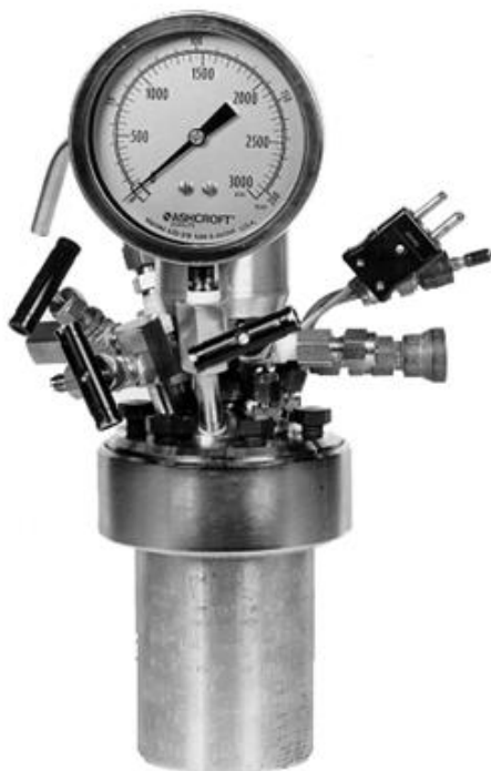
Abbildung 5.4: 300 ml Stahlautoklav der Firma Parr
