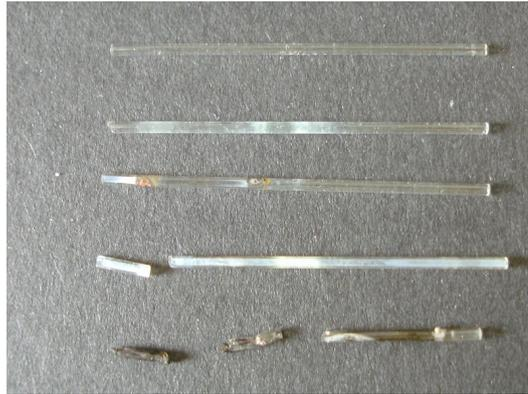
**Abbildung 5.14:** Von oben nach unten: unbenutzte Kapillare, Kapillaren mit Korrosionsspuren, an den Stellen der Ringelektroden und während des Betriebs zerstörte Kapillaren.
