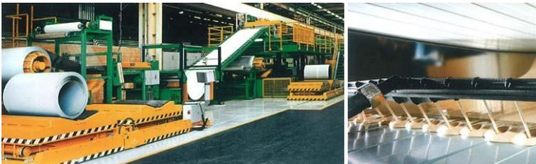
Bild 2.4: Kontinuierlicher Herstellungsprozess von Sandwichelementen [28]
