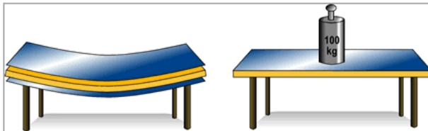
Bild 2.1: Verbundtragwirkung, sogenannter Sandwicheffekt [31]
