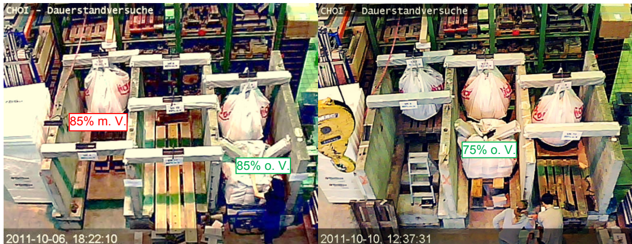
Bild 49: Bruch (85% ohne und mit Vorbelastung: links, 75% ohne Vorbelastung: rechts)
