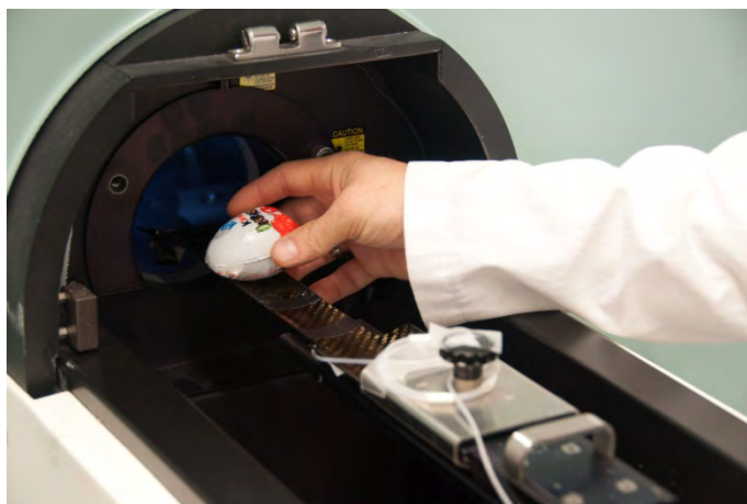
Abbildung 3: CT-Scan eines Überraschungseis in einem Kleintier-CT (European Institute for Molecular Imaging, Münster).
