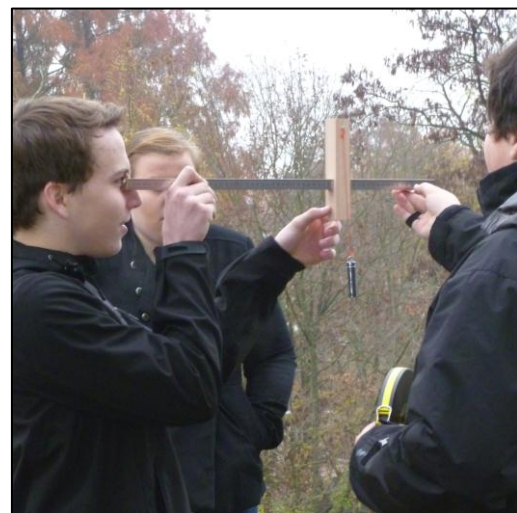
Abb. 3: Messen mit dem Jakobsstab ►
