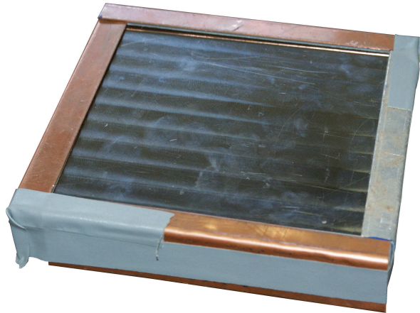
Abbildung 3.4: Stahlsubstrat der Größe 150 \times 150 \times 30 \text{ mm}^3 , dessen umlaufender Randbereich durch angebrachte Blechwinkel vor dem Sandstrahlprozess abgeschirmt wird. Der Randbereich dient später als Referenzfläche für die Digitalisierung der Probe.
