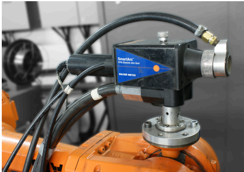
Abbildung 2.5: Spritzpistole des SmartArc Systems montiert auf einem Roboter.
