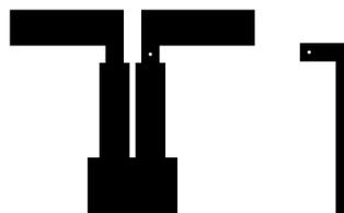
Abbildung A.6: Layout der PCB-Dipolantenne
