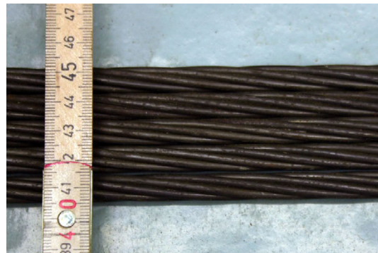
Bild 5-6: „alte“ Spannlitzen nach dem Säubern
