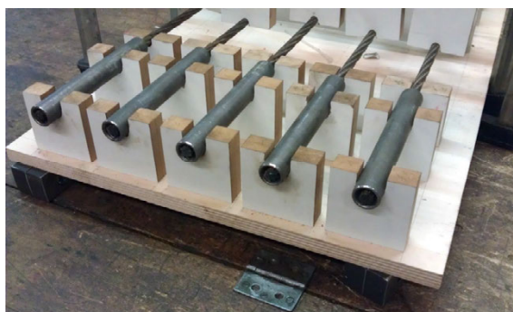
Bild 5-12: Zentriervorrichtung mit Spannlitzen und Ankerröhrchen vor dem Verkleben
