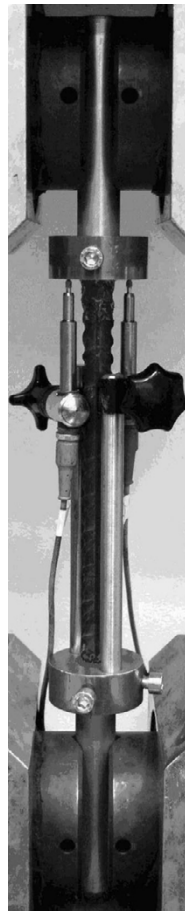
Bild 4-1: Versuchsaufbau der nicht einbetonierte Betonstahlprobe [64]
