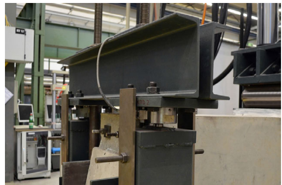
Bild 5-63: Kraftmessdosen am Auflagerbereich
