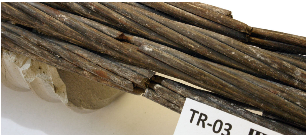
Bild A 3-27: TR03 – Spannstahl mit Drahtbrüchen
