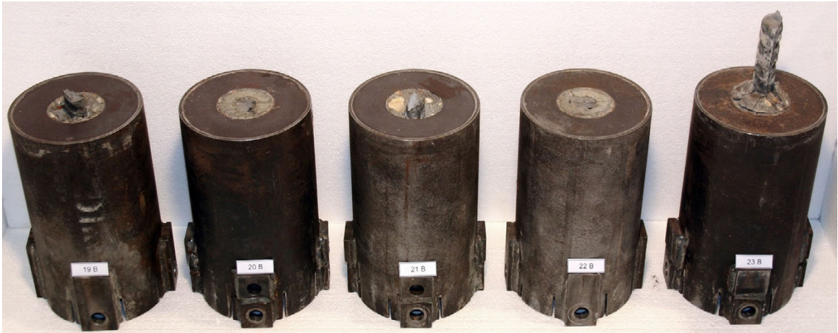
Bild 4-8: exemplarisch dargestellte untere Bruchkörper einer Versuchsreihe
