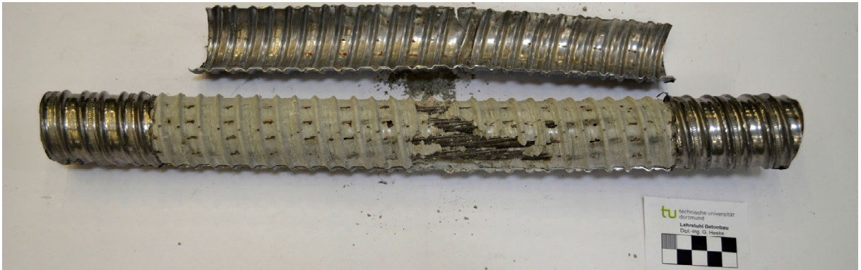
Bild A 3-62: SB04 – Entnommene Spannritzen und Hüllwellrohr
