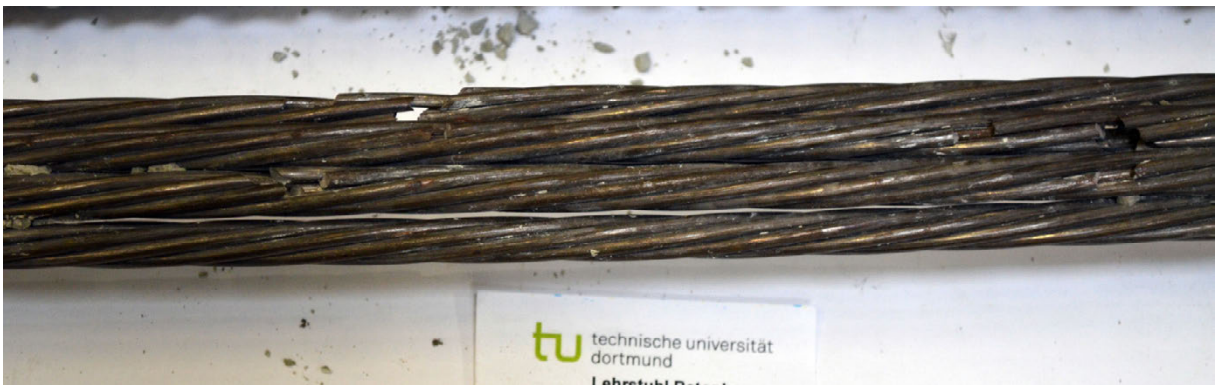
Bild A 3-63: SB04 – Spannstahl mit Drahtbrüchen
