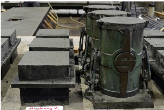
Bild A 3-8: Würfel- und Zylinderproben des Betons
