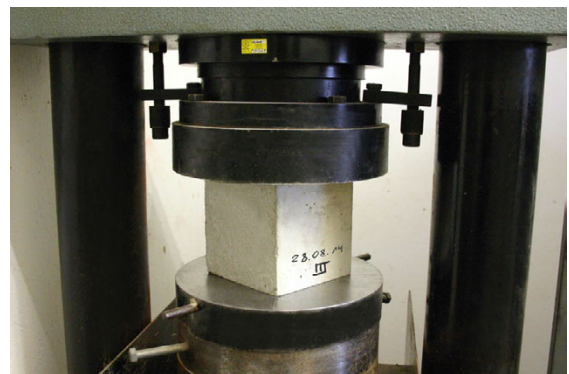
Bild 5-57: Druckfestigkeitsprüfung am Würfel
