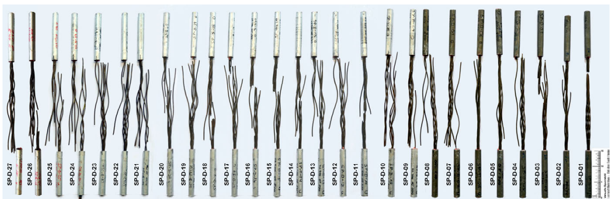
Bild 5-20: Spannstahlproben des „alten“ Spannstahls nach Versuchsdurchführung
