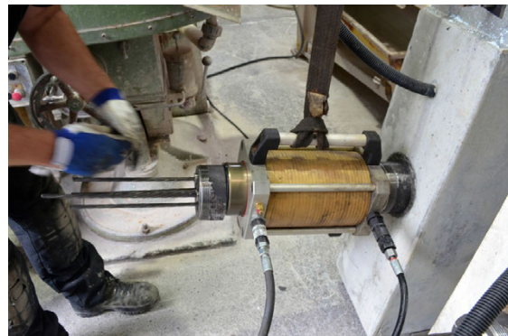
Bild 5-53: Vorspannen der Versuchsträger
