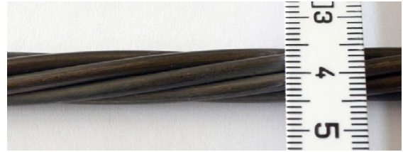
Bild 5-8: „neue“ 7-drähtigen Spannlitze, \varnothing 9,3\text{mm}
