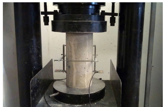
Bild 5-58: E-Modulprüfung des Betons
