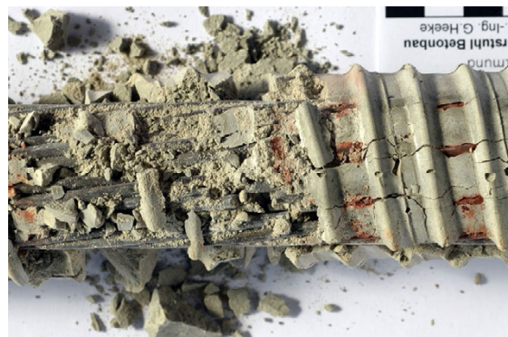
Bild 5-93: Entnommenes Spannglied im Bereich des Betonrisses, hier: SB01
