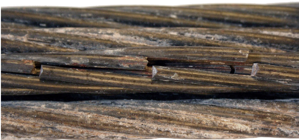
Bild A 3-40: TR05 – Detailaufnahme der Drahtbrüche
