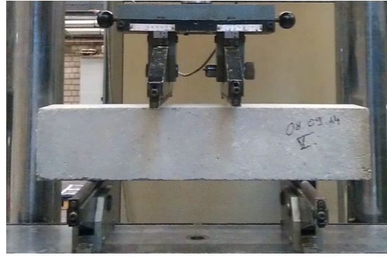
Bild A 3-6: Probe im Biegezugfestigkeitsversuch
