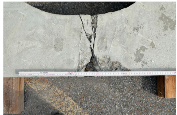
Bild 5-89: Versuchsträger im Rissbereich vor dem Öffnen, hier: SB01
