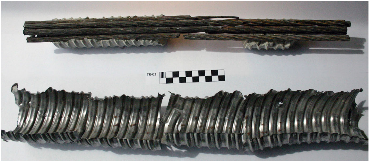
Bild A 3-26: TR03 – Entnommene Spannritzen und Hüllwellrohr
