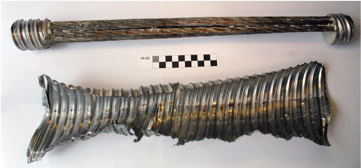
Bild A 3-20: TR02 – Entnommene Spannritzen und Hüllwellrohr
