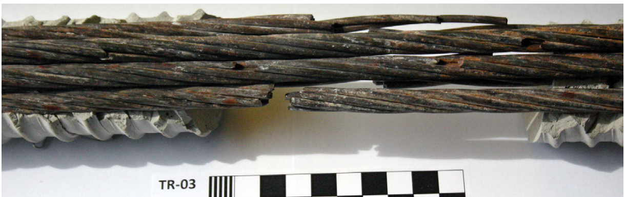
Bild A 3-27: TR03 – Spannstahl mit Drahtbrüchen
