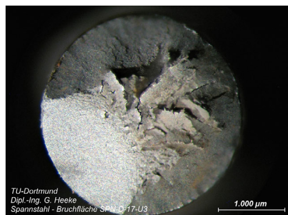
Bild 5-29: Bruchfläche eines Drahtes
