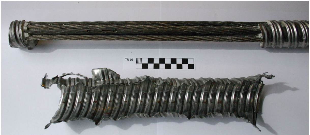
Bild A 3-38: TR05 – Entnommene Spannlitzen und Hüllwellrohr
