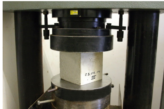
Bild A 3-10: Druckfestigkeitsprüfung am Würfel
