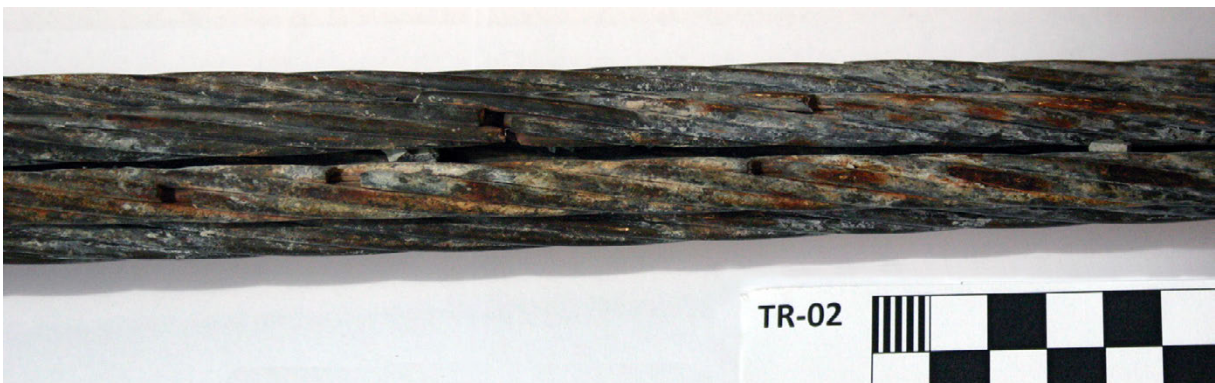
Bild A 3-20: TR02 – Entnommene Spannritzen und Hüllwellrohr
