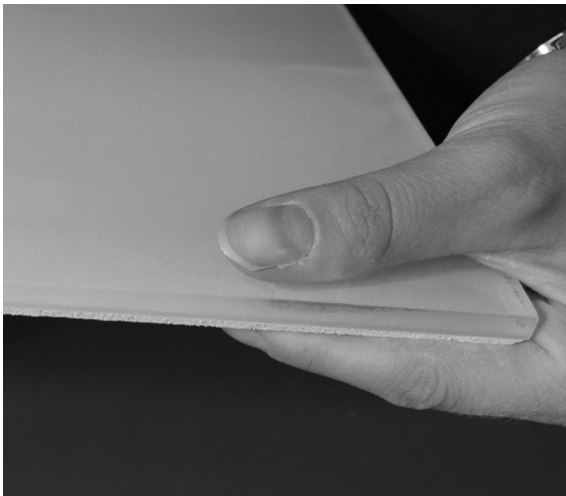
Natrium-Silikat-Glas, Float- bzw. ESG-Glas, Glasscheibendicke: 4-10 mm
