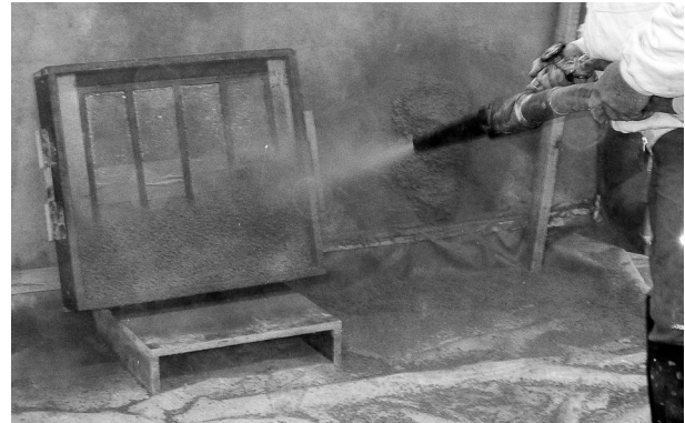
Bild 7-15: Links: Rissüberbrückungskörper zur Untersuchung textilibewehrter Spritzmörtel. Rechts: Herstellung der Rissüberbrückungskörper
