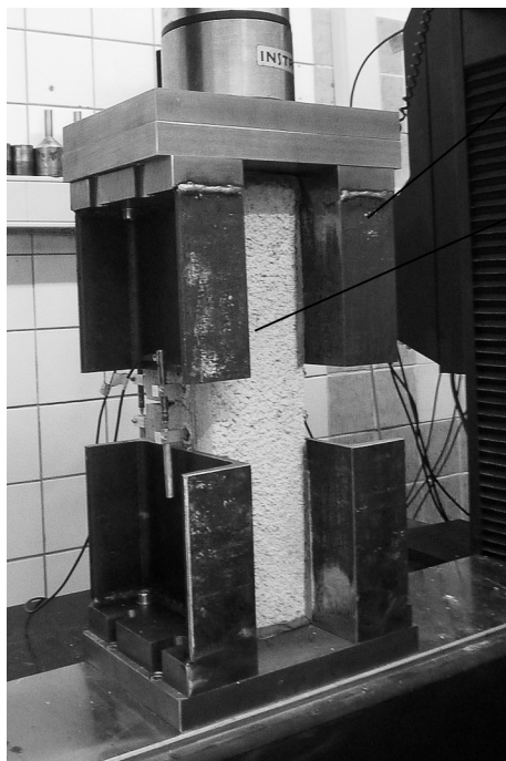
Bild 7-17: Links: Durchführung des Rissüberbrückungsversuchs. Rechts: Bruchbild – Zunächst trat der Bruch im Altbeton auf, dann folgte das Versagen in der Verbundebene Textil/SPCC
