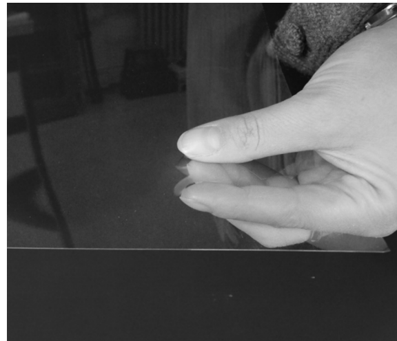
Boro-Silikat-Dünnglas, Glasscheibendicke: etwa 0,3 mm
