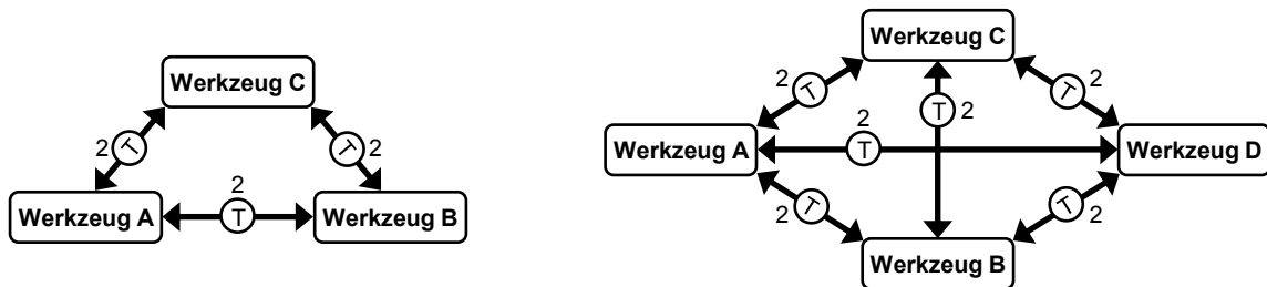
Bild 4.9: Anzahl notwendiger Regelsätze für Modelltransformationen ohne zentrales Datenmodell am Beispiel von drei und vier Werkzeugen
