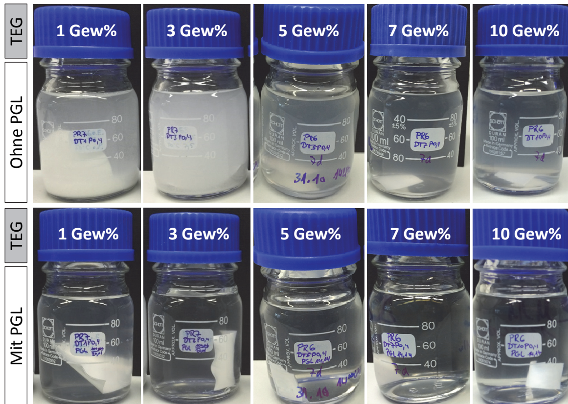
Abbildung 4.32 | Die Bilder zeigen je eine 100 ml Schraubdeckelflasche, die mit einer Calcium-2-glycerolphosphat-Lösung (11 g/l) in TEA-Puffer (0,2 M) eingestellt auf einen pH-Wert von 9,8. In jede Lösung wurde 24 h zuvor ein PDMA-I-TEG Netzwerk mit unterschiedlichem Vernetzergehalt (TEG: 1, 3, 5, 7, 10 Gew%) und 0,4 Gew% AP gegeben. Zu den in der unteren Reihe abgebildeten Filmen wurde bei der Herstellung noch Polyglutaraldehyd-Lösung zugegeben. 228
