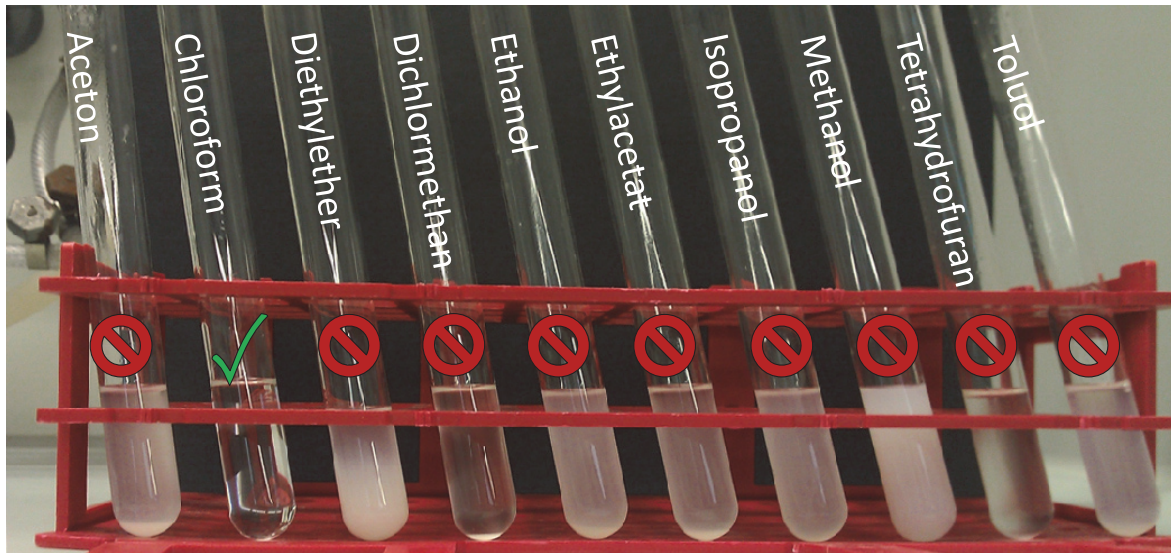
Abbildung 4.65 | DOW 5700 modifizierte Partikel, hergestellt in Ethanol bei 42°C, mit einem Durchmesser von ca. 100 nm dispergiert in verschiedenen Lösungsmitteln (Partikelkonzentration 10 mg/ml). Lösungsmittel von links nach rechts: Aceton, Chloroform, Diethylether, Dichlormethan, Ethanol, Ethylacetat, Isopropanol, Methanol, Tetrahydrofuran, Toluol. 256
