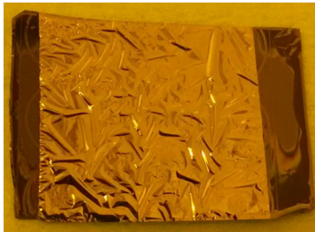
Abbildung 48: abgelöstes Bismuttellurid nach der Entwicklung
