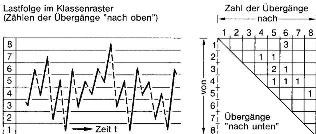
Abbildung 4-16 Zweiparametriges Klassierverfahren, Zuordnung der Umkehrpunkte der Last-Zeit-Funktion zu Ausgangs- und Zielklassen, Zählung der Übergangshäufigkeiten und Darstellung in einer Matrix [72].
