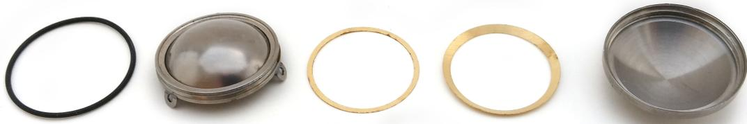
Abbildung 36: Foto der zerlegten Trägerkalotte mit Abschirmungen. Von links nach rechts ist zu sehen: Dichtungsring aus PER G80A/ FFKM81, innere Titankalotte, obere Abschirmung aus Gold, äußere Abschirmung aus Gold, äußere Titankalotte.
