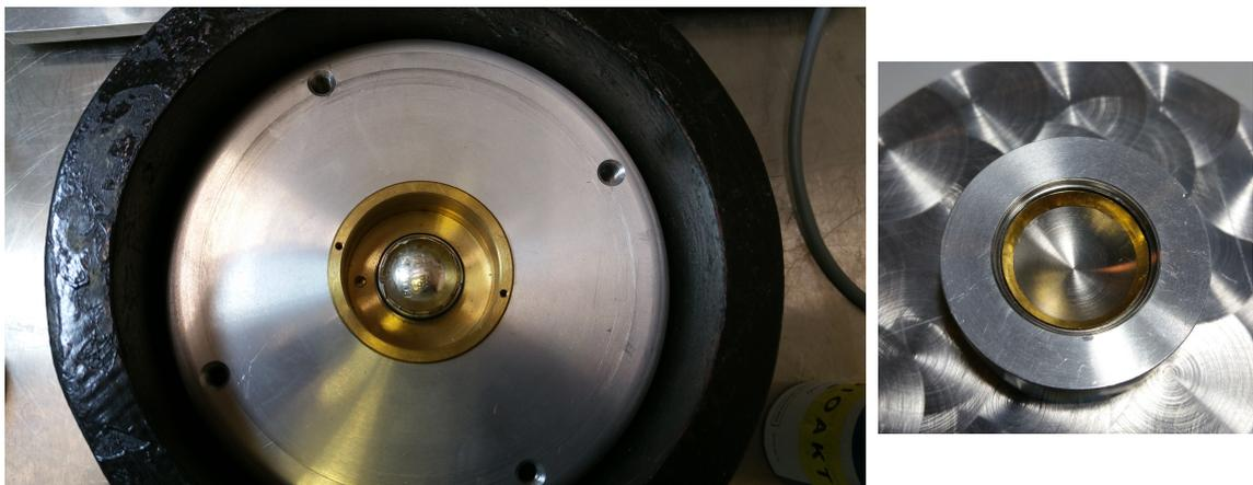
Abbildung 39: Fotografien des Binuklidapplikators. Oben, von links nach rechts: Applikatorvorderseite mit  $^{125}\text{I}$ -Seeds, CCB-Applikator, Deckel. Unten: Binuklidapplikator während des Zusammenbaus in der Montagevorrichtung: Links die Vorderseite, bestückt mit 8  $^{125}\text{I}$ -Seeds und einem CCB-Applikator, rechts der Deckel.
