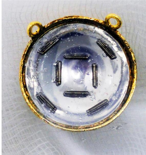
Abbildung 3: Foto eines Binuklidapplicators nach Flühs et al. [5].
