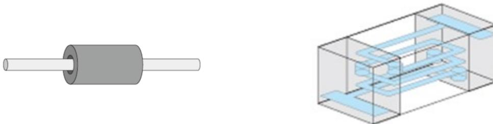
**Abbildung 3.15: Ring-Ferrit (links), SMD-Ferrit (rechts) [81].**
