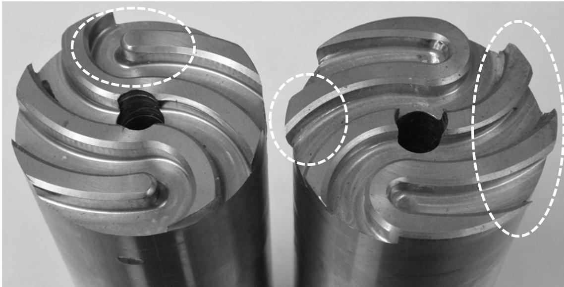
**Abbildung 12-9: Visuell erkennbare Versagenserscheinungen an der Verzahnung**
