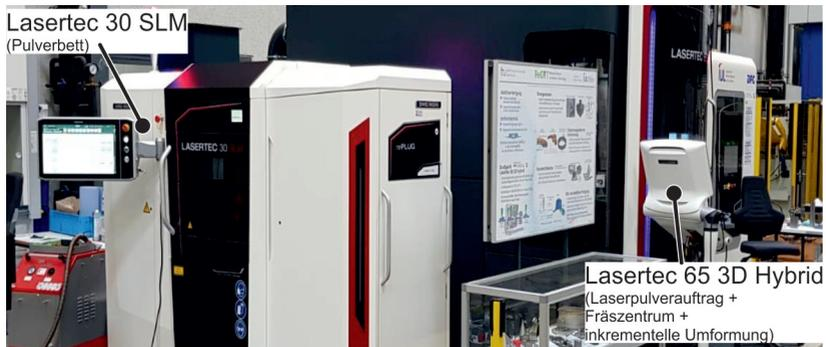
Maschinen zur additiven Fertigung auf Basis von Metallpulver am IUL
