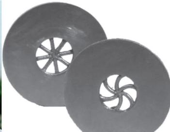
Additiv gefertigte Rohlinge
