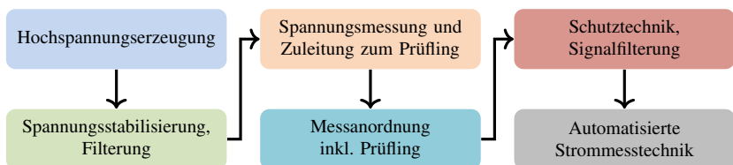
Abbildung 2.6: Überblick über Funktionsgruppen und deren Einbringungsabfolge bei messtechnischen Konzepten zur Bestimmung der (scheinbaren) Leitfähigkeit.
