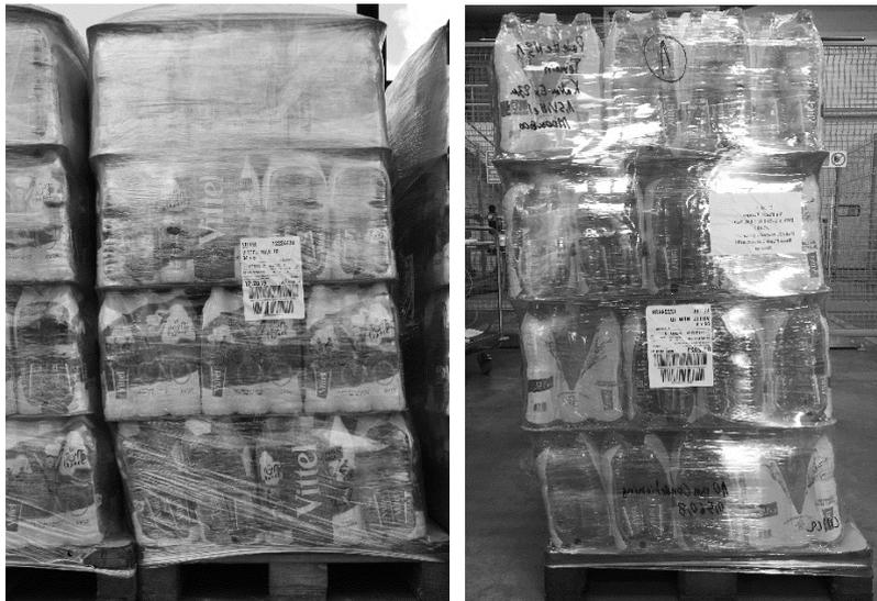
Abbildung 3.49: Wirkung des Transporttests im LKW (links) im Vergleich zur Wirkung des Transporttests im Labor (rechts) auf die globale Form der Palette. Sicht auf die schmale Seite.
