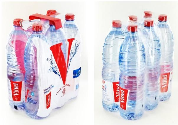
Abbildung 5.5, links: Getränkepack in der bisherigen Ausführung, rechts: mechanisch optimierter OSW-Pack, verpackt durch Lanfranchi [94]
