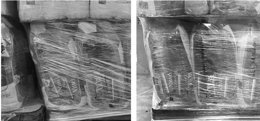
Abbildung 3.51: Wirkung des Transporttests im LKW (links) im Vergleich zur Wirkung des Transporttests im Labor (rechts) mit Fokus auf die Getränkepacks
