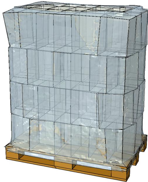
Abbildung 4.22: Aufbau des Strukturmodells der Palette in der Ausgangskonfiguration
