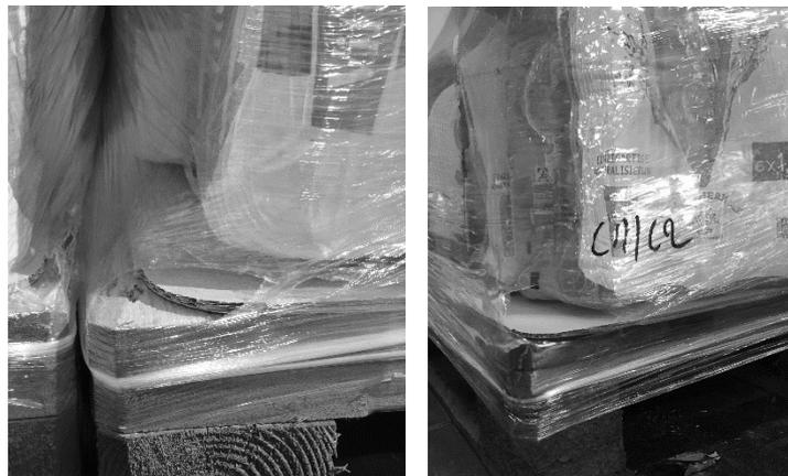
Abbildung 3.52: Wirkung des Transporttests im LKW (links) im Vergleich zur Wirkung des Transporttests im Labor (rechts) mit Fokus auf die Stretchfolie
