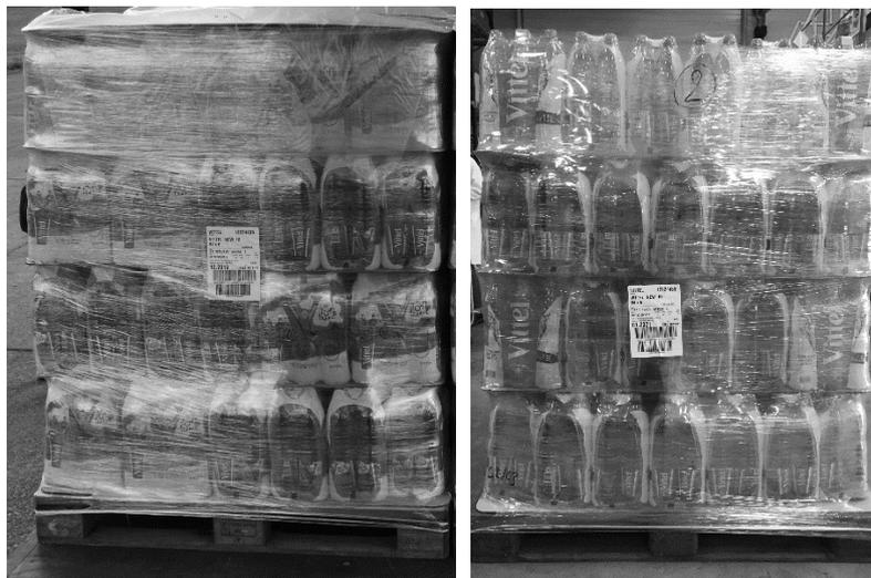
Abbildung 3.50: Wirkung des Transporttests im LKW (links) im Vergleich zur Wirkung des Transporttests im Labor (rechts) auf die globale Form der Palette. Sicht auf die breite Seite.
