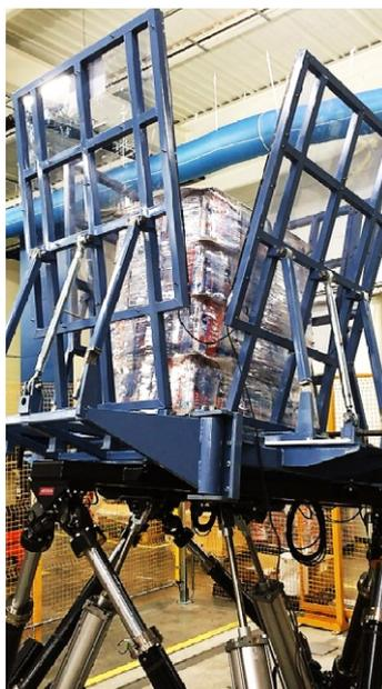
Abbildung 3.39: Hexapod System für den Transporttest von Getränkepaletten, Abbildung aus einer Masterarbeit der Arbeitsgruppe [63]
