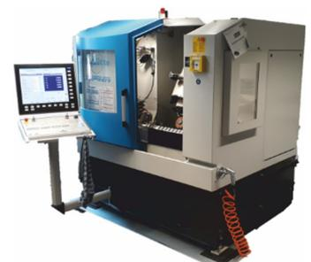
Abbildung 4.1.1.1: Versuchsmaschine zur Anpassung der Umfangsgestalt und Oberflächentopographie
