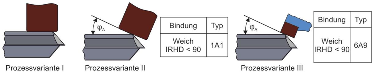
Abbildung 4.1.1.3: Darstellung der Prozessvarianten sowie der Polierschleifscheiben
