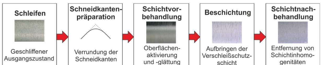
Abbildung 2.1.1. Prozessabfolgen in der Prozesskette von VHM-Werkzeugen (eigene Darstellung nach [60])
