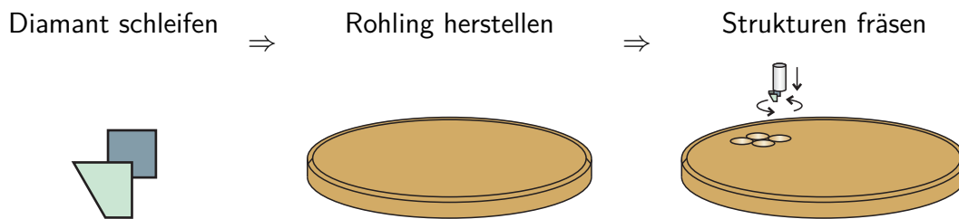
Abb. 4.7: Prozess zur mikromechanischen Herstellung des Formwerkzeugs mittels Diamantfräsen.
