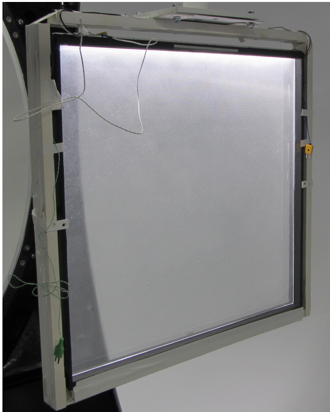
Abb. 5.27: Eingeschalteter, von Jungbecker heißgeprägter, industriell gefertigter Flächenstrahler integriert in einen Scheibenverbund von Saint-Gobain und angebracht in der geöffneten Ulbricht-Kugel am FhG-IBP.
