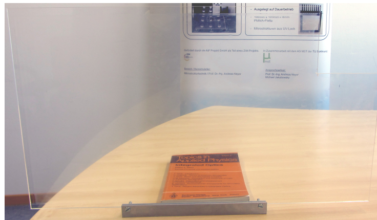
Abb. 4.19: Aufnahme einer 0,3\ \text{cm} \times 30\ \text{cm} \times 60\ \text{cm} LGP mit 28\ \mu\text{m} hohen Zylindern hergestellt von temicon mittels Rolle-zu-Platte UV-Prägen. Eine 10\ \text{cm} \times 10\ \text{cm} Ecke der Platte (oben rechts) wurde für die Vermessung der Strukturen herausgesägt.
