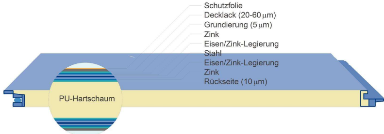
Bild 2.30: Typischer Aufbau Wand-Sandwichelement im Bauwesen [36]
