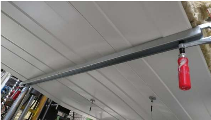
Bild B.7: C-Profile in den Fünftelpunkten zur Queraussteifung der Versuchskörper
