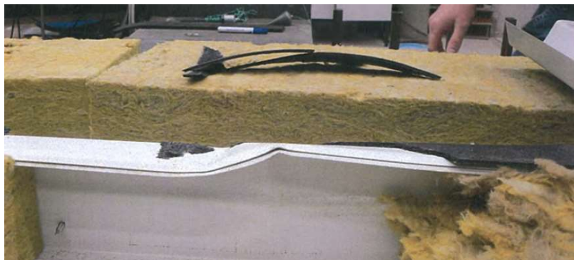
Bild 6.8: Versagensbild der Versuchsreihen 1 bis 4 [43]
