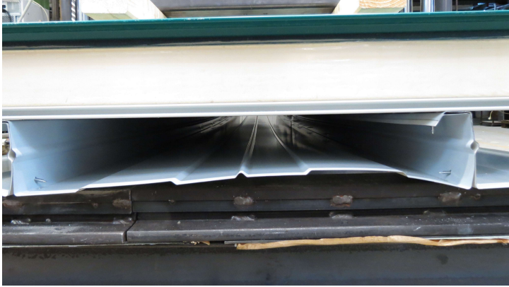
Bild 6.40: Gurteindrehung bei K100_S120_MW01
