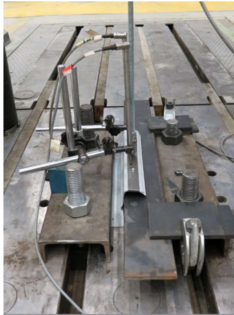
Bild 8.5: Versuchsaufbau zur Bestimmung der lokalen Steifigkeit der Auflagerung bei andrückender Belastung [40]
