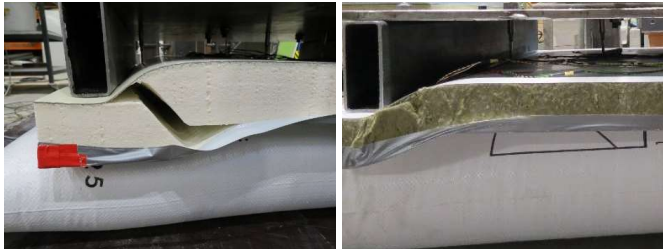
Bild 2.42: Schubbruch einer PU-Kernschicht (links) und einer MW-Kernschicht (rechts)
