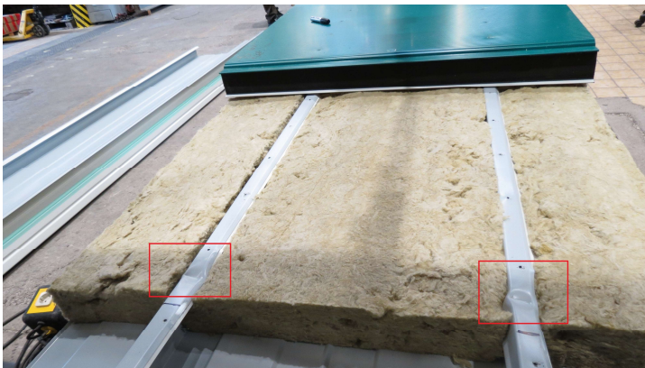
Bild 6.35: Versagen unterhalb einer mittleren Längsfuge bei K100_S120_SB03
