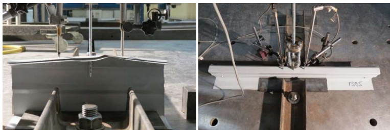
Bild 8.4: Versuchsaufbau zur Bestimmung der lokalen Steifigkeit der Auflagerung bei abhebender Belastung [40]
