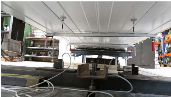
Bild B.11: Seilwegaufnehmer in Feldmitte zur Aufzeichnung der vertikalen Verformungen
