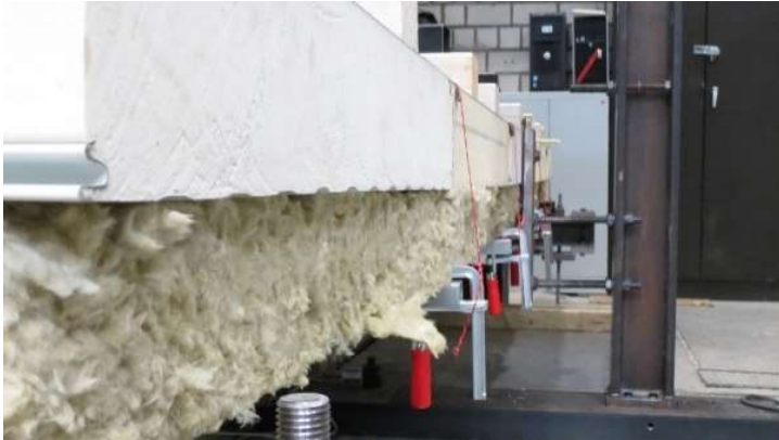
Bild B.8: PE-Schnur (rot) zur Begrenzung vertikaler Verformungen der freien Ränder der halbierten Kassettenprofile
