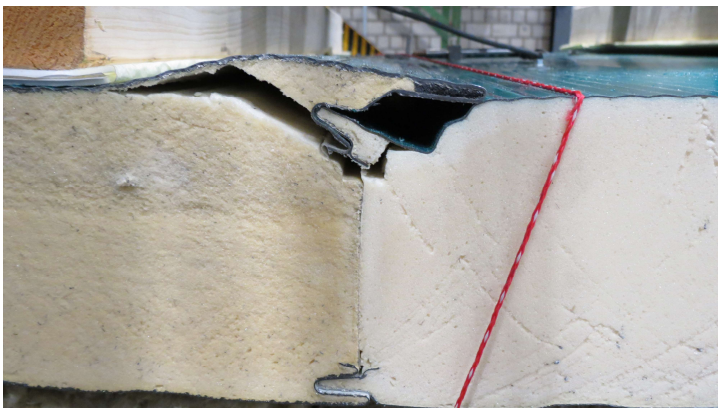
Bild 6.54: Druckversagen in der Längsfuge bei K100_S120_O_SB03
