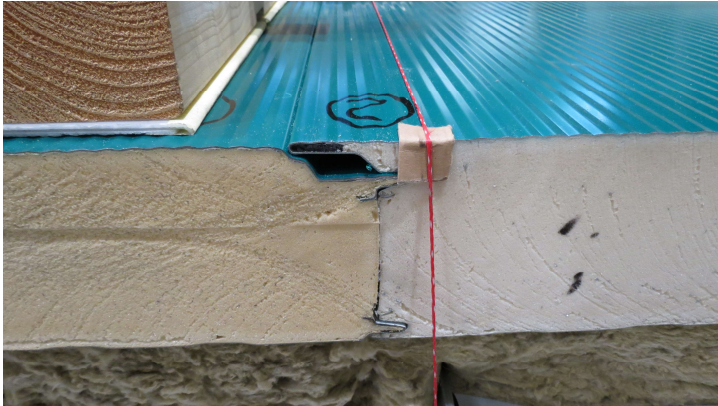
Bild 6.49: Längsfugenbreite bei Versuchsbeginn
