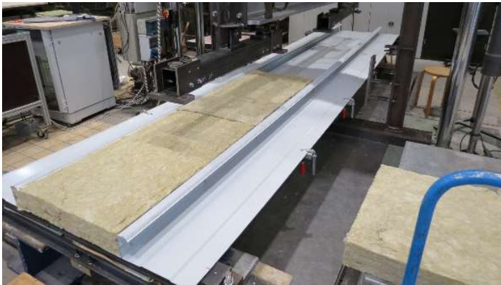
Bild B.3: Verbundene Kassettenprofile beim Einlegen der Mineralwolle
