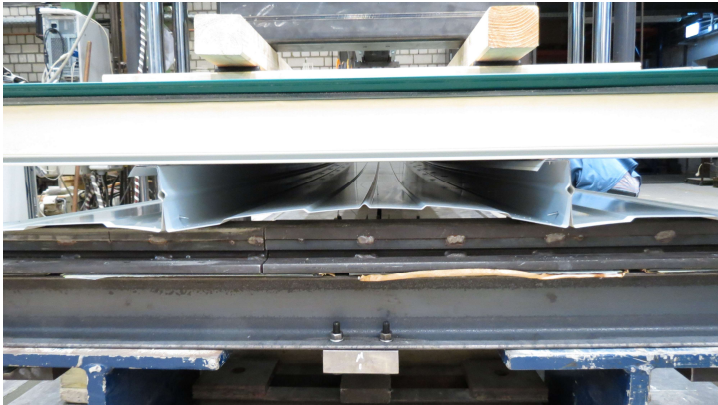
Bild 6.39: Gurteindrehung in Form einer Halbwelle bei K100_S120_MW02
