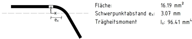
Bild C.2: Querschnittswerte wirksame Fläche der Randsteifen A_s
