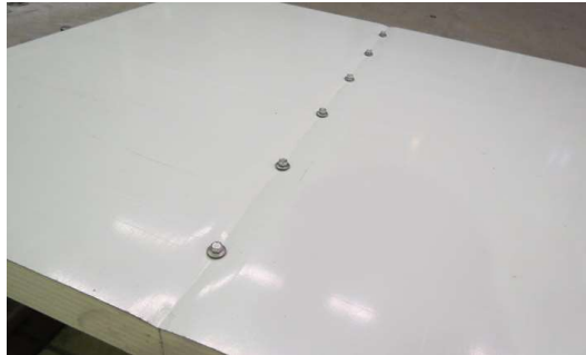
Bild 2.38: Lokale Imperfektionen im Bereich der Schraubenköpfe reduzieren die Knitterspannung
