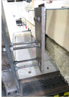
Bild B.10: Seitliche Lagerung der Außenschale in Feldmitte
