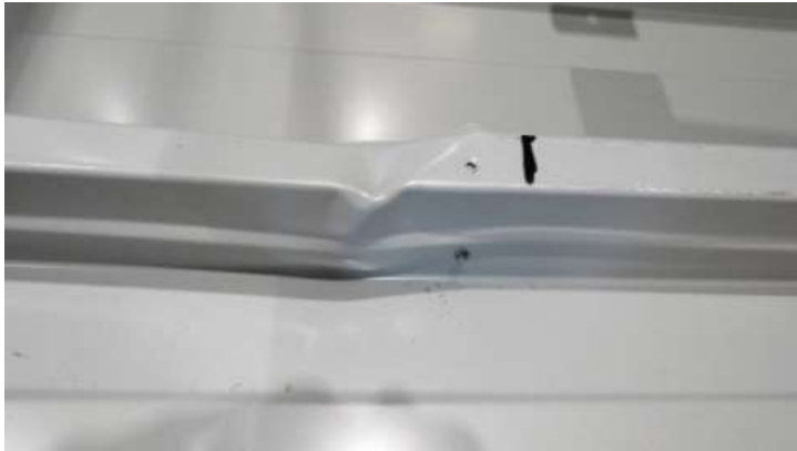
Bild 6.13: Typisches Versagensbild bei den eigenen Biegeversuchen
