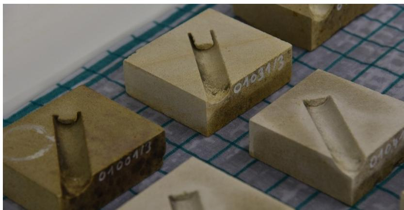
Abb. 3-21: Darstellung des Versuchs während der Messung der kapillaren Wasseraufnahme.
