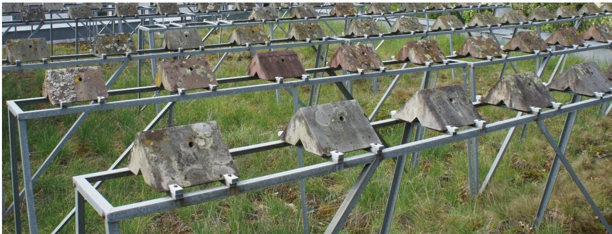
Abb. 3-1: Dreiecksprismatische Prüfkörper der Freilandexpositionsstudie des BMFT-Verbundprojektes, Standort Kempten im März 2017.
