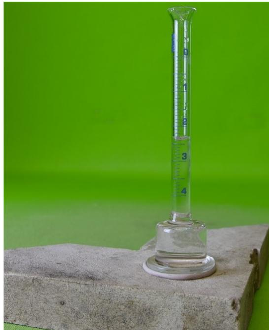
Abb. 3-22: Messaufbau Karstenmessung, mit einem Prüfrohr vom Typ H.
