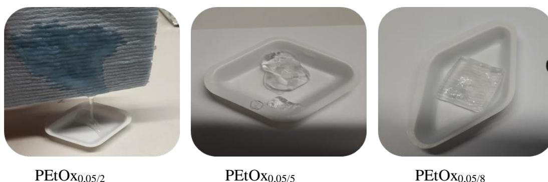
**Abbildung 5.8** In Wasser gequollene Proben mit 0,05 Gew.-% DCP und mit verschiedenen DCP:TAIC-Verhältnissen.<sup>460</sup>
