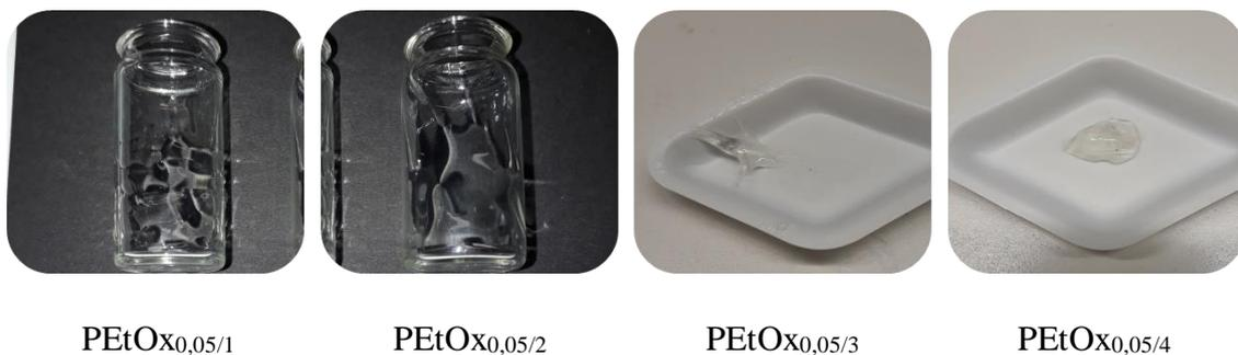
**Abbildung 5.13** In Wasser gequollene Proben mit 0,05 Gew.-% DCP bei unterschiedlichen DCP:TAIC-Verhältnissen und einer Quelltemperaturen von 72 °C.<sup>460</sup>
