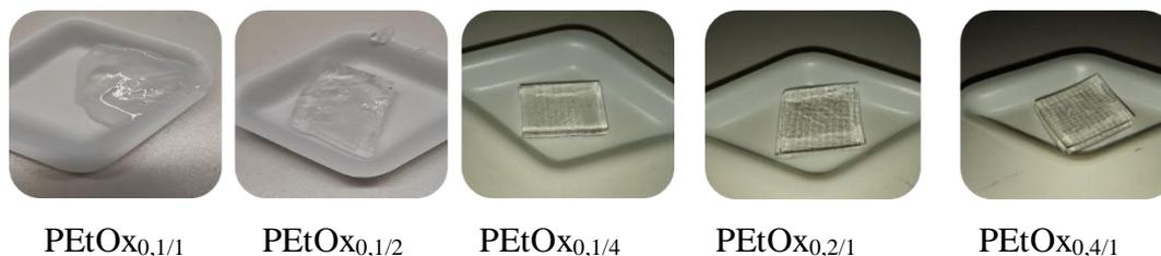
**Abbildung 5.12** Vergleich der optischen Formstabilität von in Wasser gequollene Proben mit verschiedenen DCP-Konzentrationen bei einem DCP:TAIC-Verhältnis von 1, 2 und 4.<sup>460</sup>
