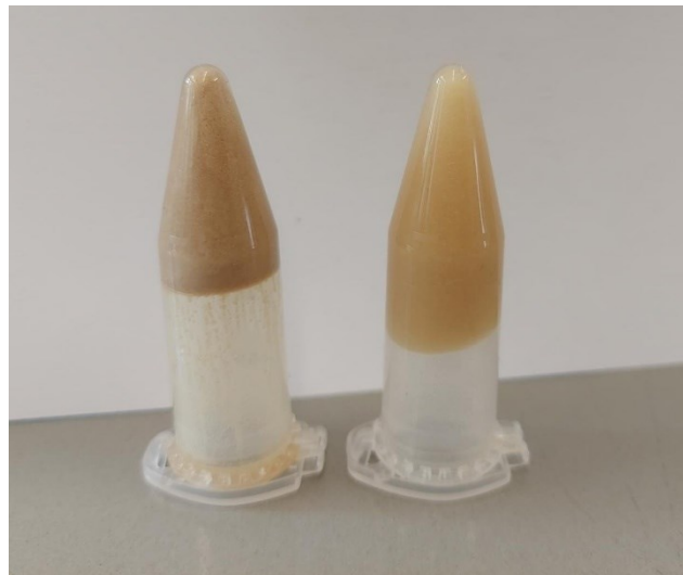
Abb. 74: Bestandener Tube-Inversion-Test der Polyamidsysteme AS-MDA (8,3, RZÖ) (links) und DCF-BAMF (8,9, RZÖ) (rechts).
