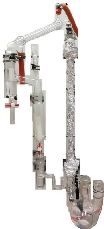
Abb. 82: Umlaufapparatur der Polykondensation der Polyesterverdicker.
