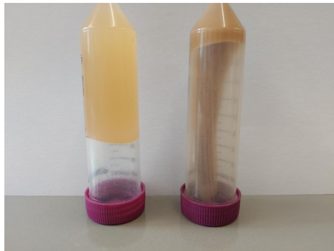
Abb. 32: Der Tube-Inversion-Test am Beispiel von zwei Proben (links bestanden, rechts nicht bestanden).
