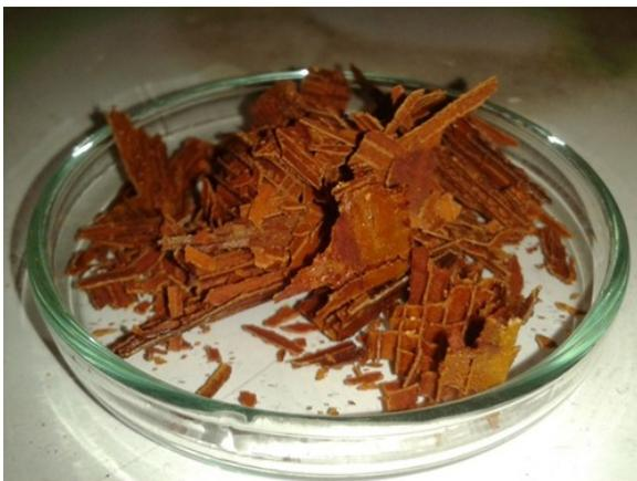
Abb. 5-13: Thermische Stabilität des PEI-impregnierten Adsorbens
