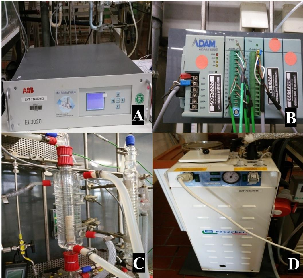
Abb. 5-21: Geräte und Apparate (A: Gasanalysator, B: Temperatursensoren, C: Adsorber, D: Verdampfer)
