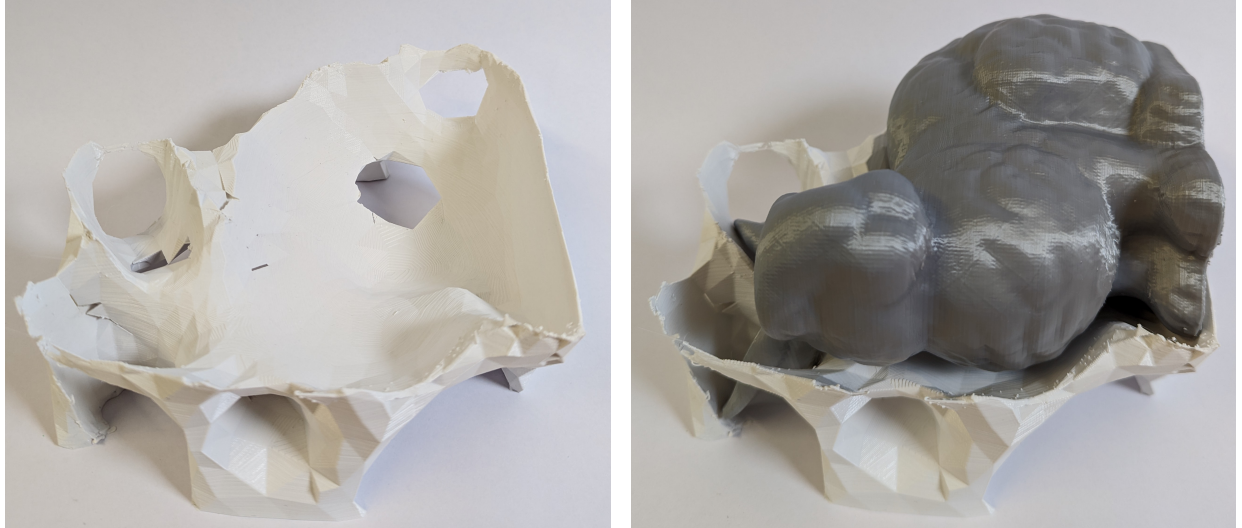
Abbildung 9.2.: Gefertigter optimierter Ladungsträger des Stanford Bunny auf Basis der Heuristik
