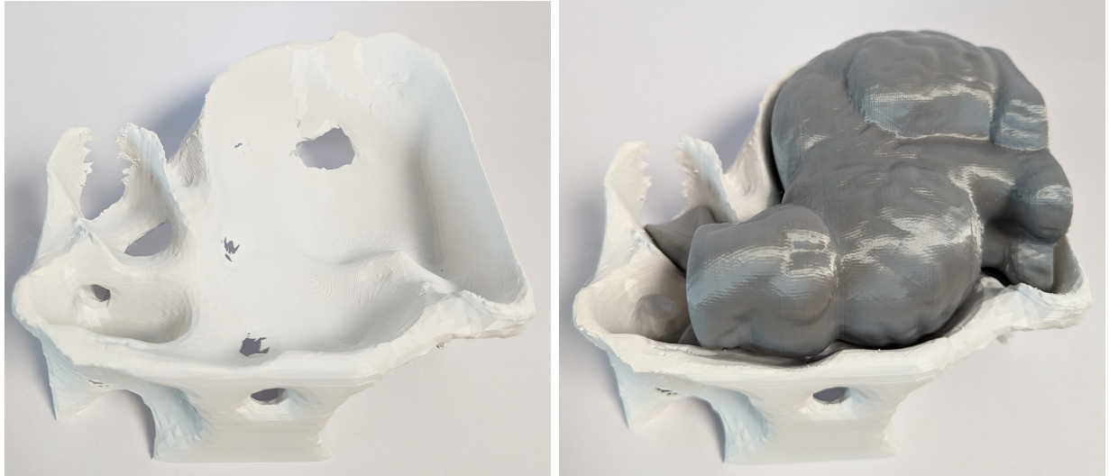
Abbildung 9.3.: Gefertigter optimierter Ladungsträger des Stanford Bunny auf Basis der Heuristik mit feinerer Vernetzungsaufösung ( H_{\max} = 5 \text{ mm} )
