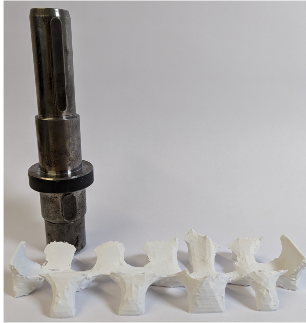
Abbildung 9.7.: Auf der Basis der Heuristik optimierter Ladungsträger für eine Welle ( H_{\max} = 5 \text{ mm} )
