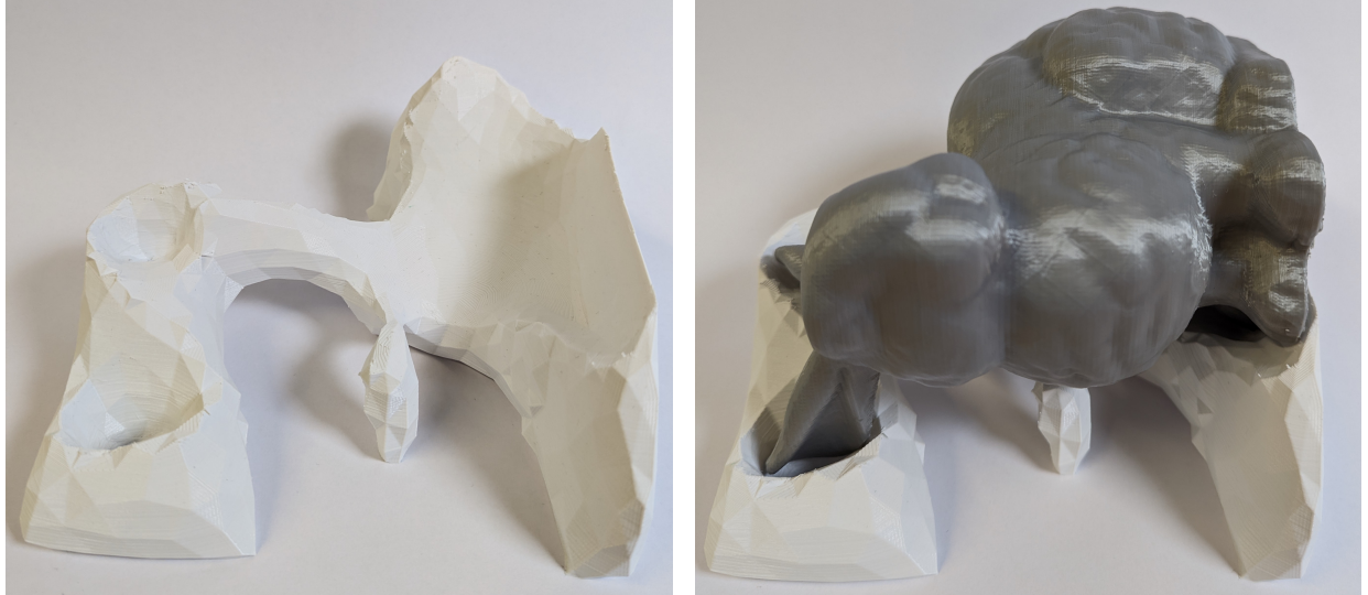
Abbildung 9.1.: Gefertigter optimierter Ladungsträger des Stanford Bunny auf Basis simulierter Belastungen
