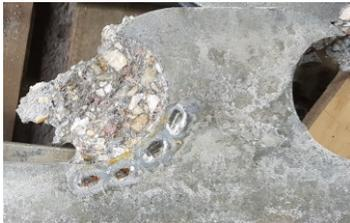
*Abbildung 5-11: Herausgetrennte Dübelleiste nach Versuch V2 mit verdichtetem Beton*
