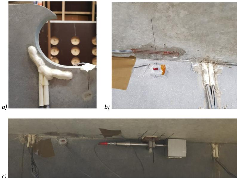
Abbildung 7-7: a) DMS-Messstellen am Dübel mit Schutzschicht; b) DMS an Steg und Beton; c) Schlupfmessung durch Wegaufnehmer
