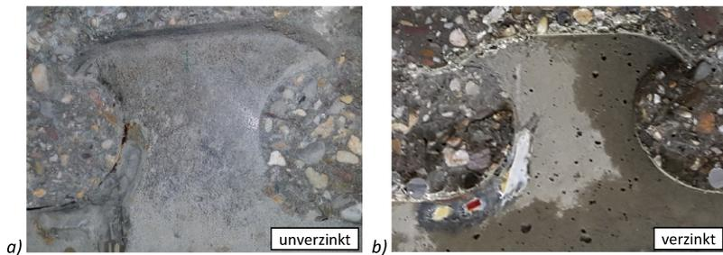
Abbildung 5-14: Oberflächenbeschaffenheit Beton an Kontaktfläche zu Stahl bei a) unverzinktem Versuch UV2, b) verzinktem Versuch V1
