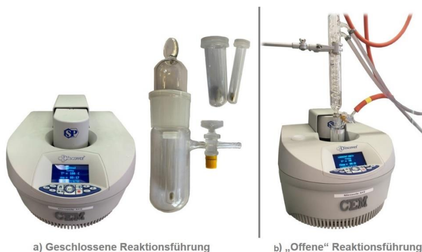
Abbildung 4.1: Mögliche Reaktionsführungen bei Mikrowellensynthesen, a) geschlossene Reaktionsführung und b) offene Reaktionsführung. Als Mikrowelle wird die Discover SP von CEM verwendet.
