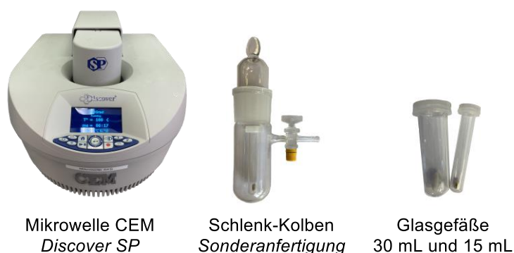
Abbildung 2.18: Von links nach rechts: Mikrowelle Discover SP der Firma CEM, Schlenk-Gefäß zum Befüllen der Mikrowellengefäße unter Schutzgas und Glasgefäß für die Mikrowelle.
